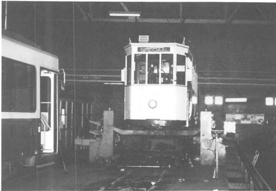
De tramkast van de 354 in de hoogte tijdens het herkableren in de stelplaats te Oostende.
