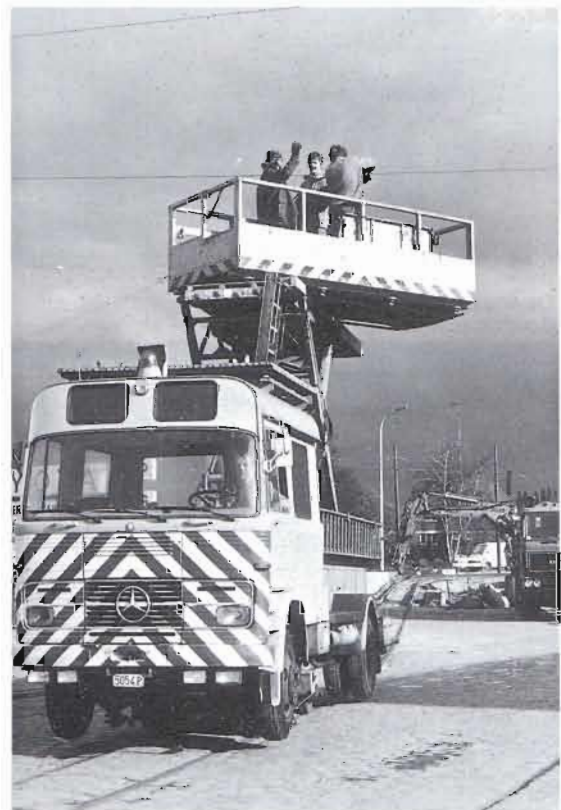
Mercedes-Schörling ladderwagen voor het monteren van de bovenleiding.
