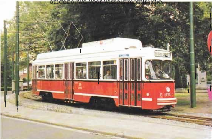
Terminus Lelieplaats Hoboken — 12.7.1984; PCC 2050 omgebouwd voor wisselstroomtractie
