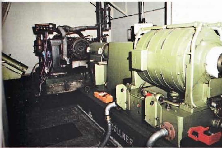
Vermogenreinstallatie Zöllner C 500 A — MIVA-garage — 25.4.1988.
