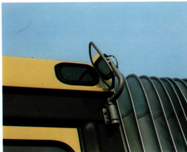
De gelede bus is uitgerust met een gesloten televisiesysteem: twee camera's laten de chauffeur toe, ook bij stilstand in een bocht, vanuit zijn stuurpost toezicht uit te oefenen op de zijwanden en de deuren van de aanhangwagen.
