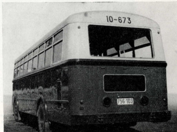
(Fig. 3.) Moteur disposé à l'arrière.
