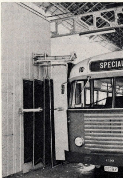
Le tunnel extensible de la machine à dépoussiérer a été appliqué à la baie de la porte avant.
