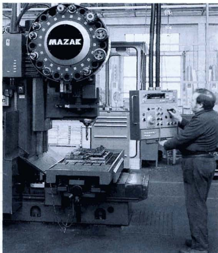
Centre d'usinage à commande CNC (Computer Numerical Controlled) pour forage et fraiseage à Destelbergen.
