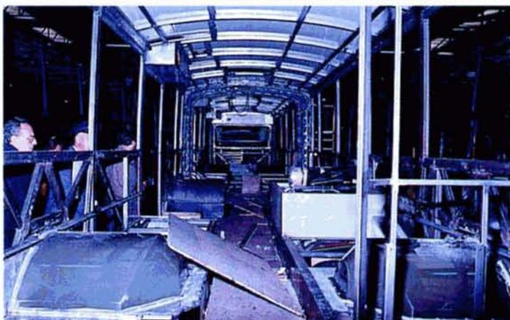
Le châssis d'un autobus articulé.
