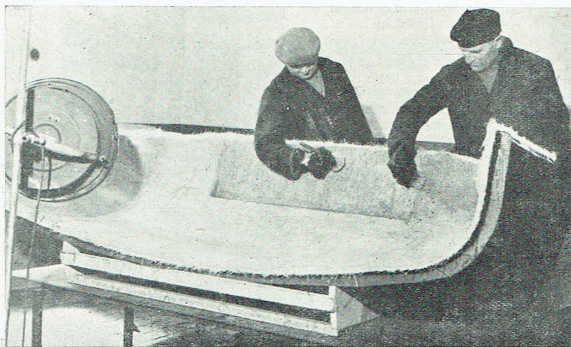
J. Dirix en W. Neven doppen « polyester resin » op de glaswol. Links wordt het afgewerkte deel reeds gedroogd met behulp van infra-roodbestraling.
