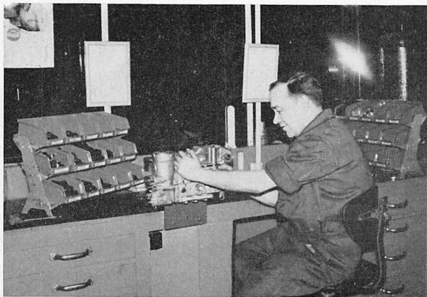
De heer Michiels aan zijn werkpost onderzoekt een apparaat, dat hij gezuiverd heeft. Hij zal nu al de uitneembare delen controleren en eventueel de defecte stukken vervangen : de bakjes bevatten dichtingen en kleppen van verschillende afmetingen.
