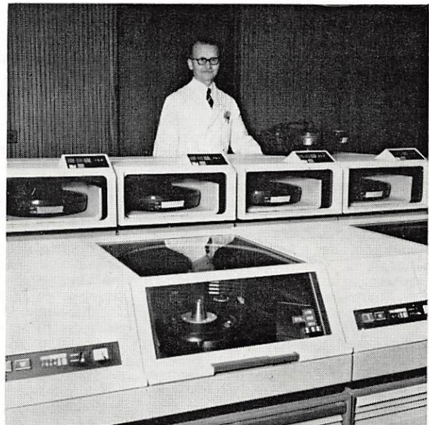
De b. Steux, operator, en kasten met magnetische schijven. De vier schijven op de achtergrond, alhoewel van klein formaat, hebben elk een capaciteit die tienmaal hoger ligt dan die van de schijf op de voorgrond.
