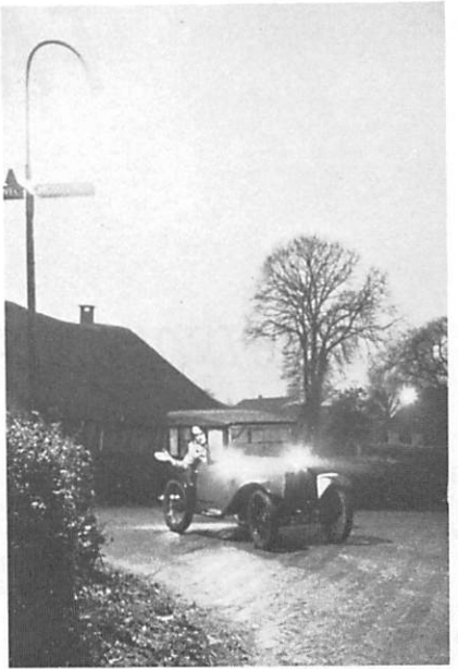
In 1924: een autolamp met twee gloeidraden in één ballon: een voor grootlicht en een voor dimlicht. De eerste Duplo-autolamp was er.
