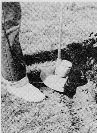
Deze maaimachine is zeer praktisch daar het dunne nylon touw dat met grote snelheid draait, het gras afsnijdt op moeilijk toegankelijke plaatsen. Kijk naar deze vrouw, ze vraagt om problemen met haar sandalen. Het gebrek aan voorzorg in de keuze van de kledij en schoenen kan pijnlijke verwondingen veroorzaken.
