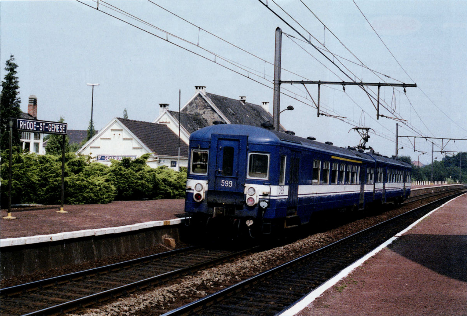
↑ FOTO 119-55 Sedert juni 1984 vereisten de diensten naar de Luchthaven slechts de inzet van drie motorstellen. Hierdoor zien we sporadisch een SABENA-stel diensten uitvoeren van andere reeksen motorstellen. Ze kwamen vooral voor bij de stoptreinen naar Nivelles. Op 24 juli 1984 stopt de 599 (ex-855) te Sint-Genesius-Rode met de L8084 Nivelles - Brussel-Noord. Jean-Luc VANDERHAEGEN.
