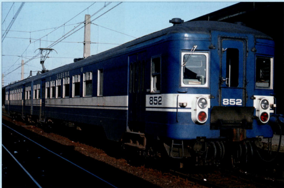
↑ De 852 in Brussel-Noord. In tegenstelling tot de motorstellen van de types 66 en 70 hadden de SABENA-stellen geen toegangsdeuren op het einde van het AD-rijtuig. Deze ruimte werd door de bagageafdeling ingenomen. De plaats waar zich normaal het toegangsplatform had moeten bevinden is links van de deur die toegang geeft tot de bagageafdeling. Er is op deze plaats geen raam voorzien. Julien CASIER, verz. TSP.
