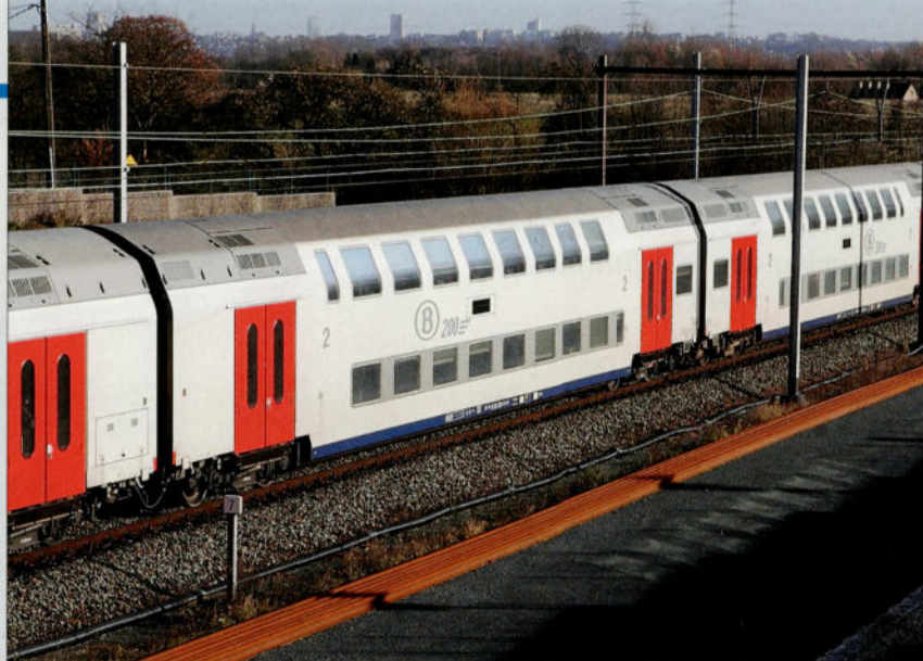
FOTO 119-20 ↑ Buiten het logo "200", zien we nog twee rode merktekens aan de uiteinden van de kasten ter hoogte van de buffers (als visueel hulpmiddel bij de rangeringen). Hierboven het B-rijtuig 62.244. Jean-Luc VANDERHAEGEN.
