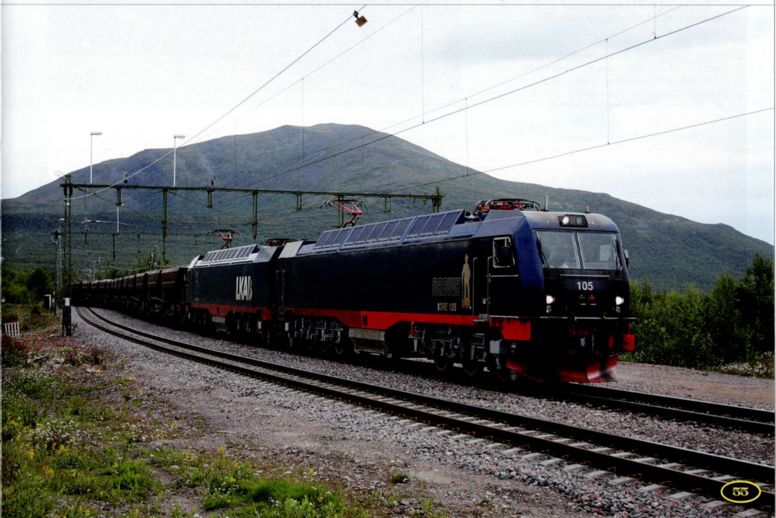
FOTO 119-91 De Dm3's werden vervangen door 17 gelede locs die gebouwd werden door Bombardier en ze zijn geënt op het TRAXX-platform. We zien de 105 + 106 (in dienst op 7 maart 2002) aan het werk te Bergfors op 23 juli 2009. Philippe DE GIETER.
