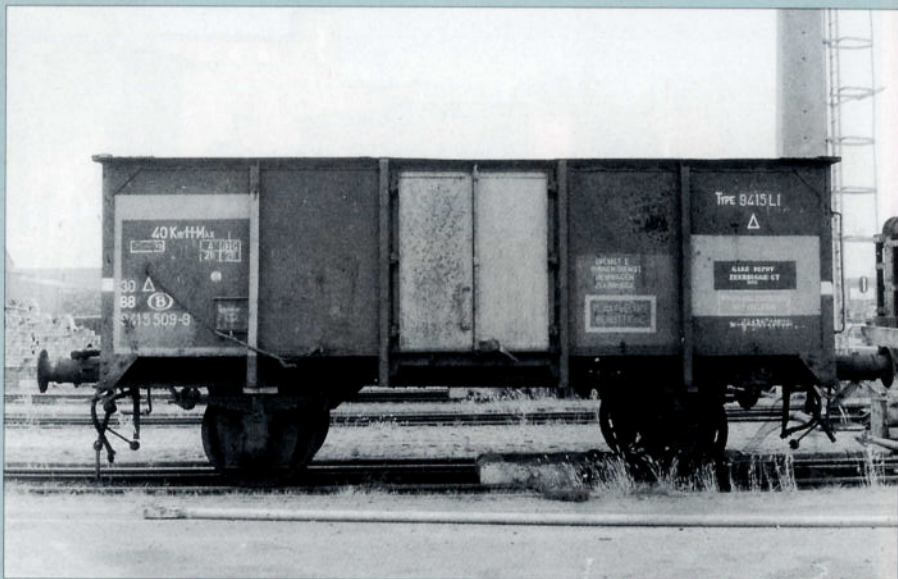
↑ Dienstwagen 30 88 941 5 509-9 (type 9415L1, vroegere type 1212D2) werd in de jaren '70 gebruikt als schutwagen in de terminal van Ferry-Boats in Zeebrugge om containerwagens onder de portaalkranen te plaatsen. Roger CRIKELAIRE.
