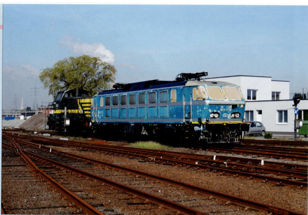
Na het afschuren en kleine polyesterherstellingen, is de kast klaar om in het groen geschilderd te worden. Geert PACKET / TSP.
