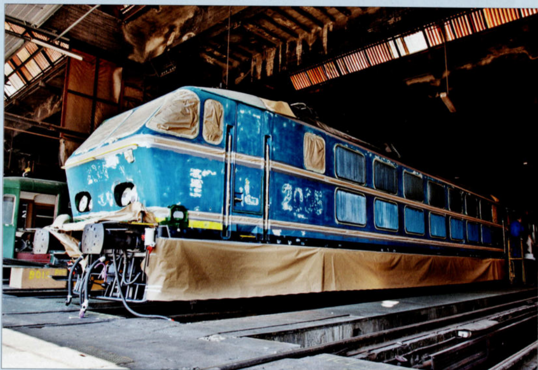
Na het afschuren en kleine polyesterherstellingen, is de kast klaar om in het groen geschilderd te worden. Geert PACKET / TSP.
