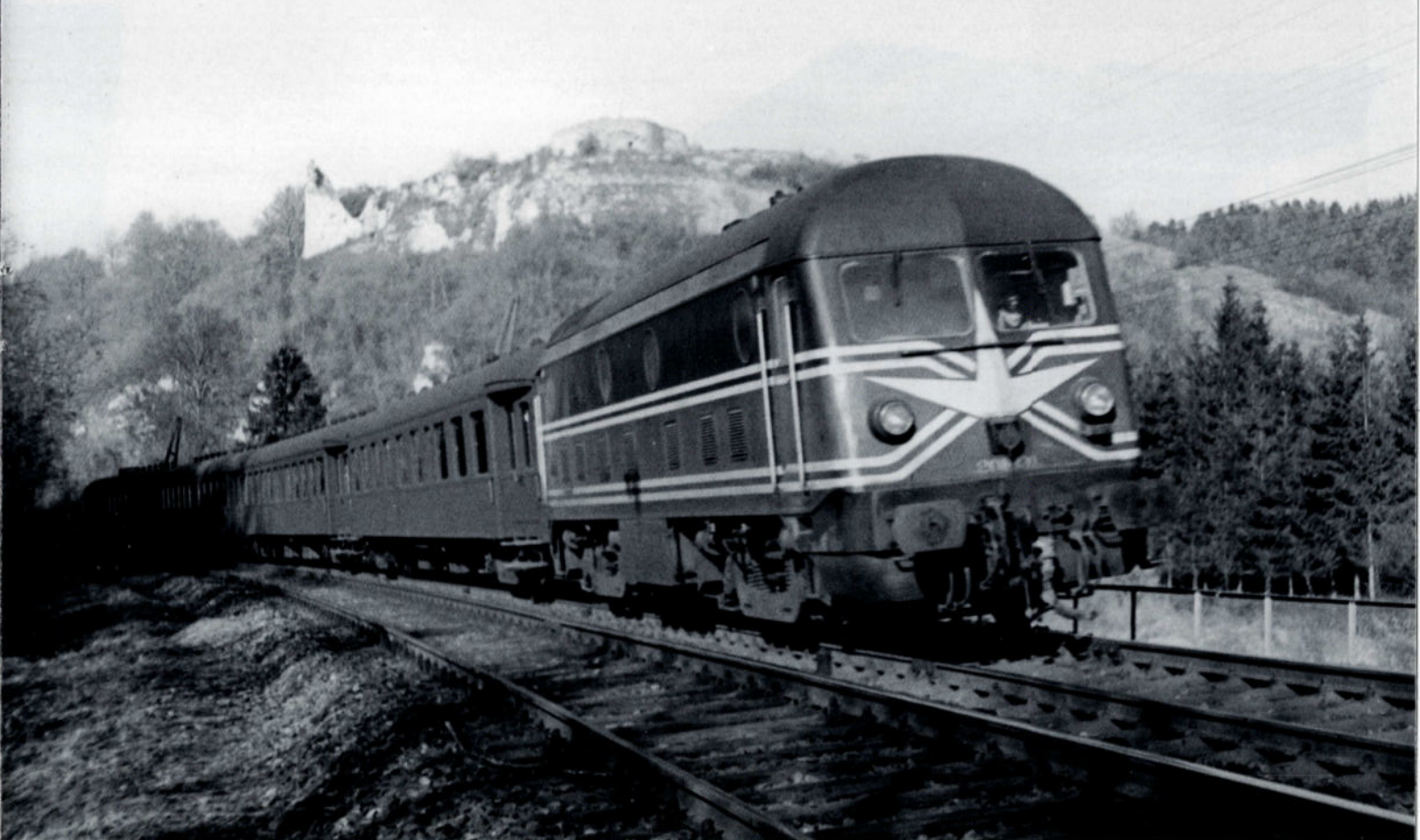
FOTO 122-64 ZW De 201.030 sleept de semi-direct 4832 Liège - Jemelle op 15 februari 1959 en werd gefotografeerd tussen Sy en Bomal. Na haar levering is deze locomotief voorzien van handgrepen onder de voorruit. Bruno DEDONCKER, verzameling TSP.
