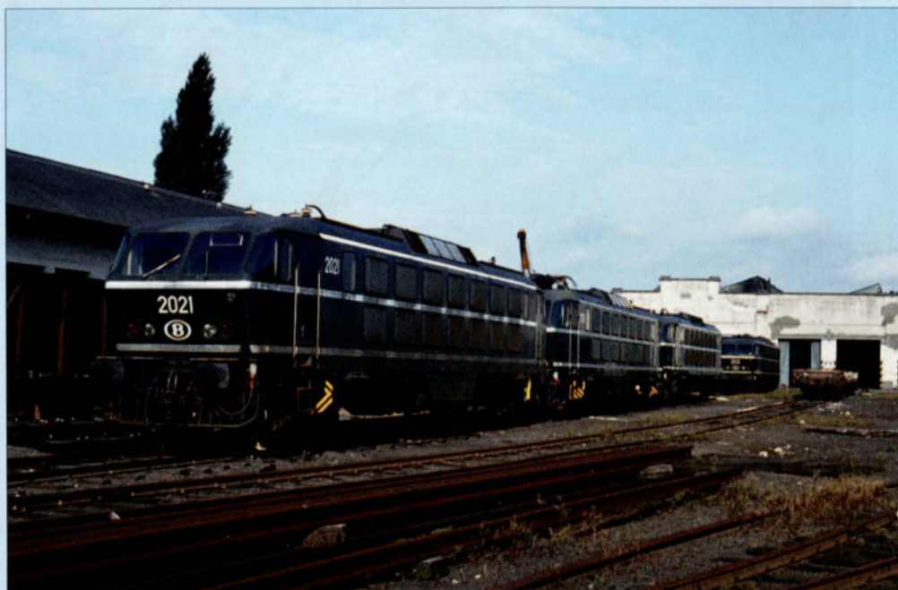
FOTO 125-05 De machines van de reeks 20 kenden grote problemen wat hun betrouwbaarheid betrof. De overbrenging was erg kwetsbaar en moest op alle machines aangepast worden. Dit gebeurde in de Centrale Werkplaats van Luttre. In september 1982 wacht de 2021, in gezelschap van haar reeksgenoten, op de terugkeer van haar draaistellen. Pierre HERBIET.
