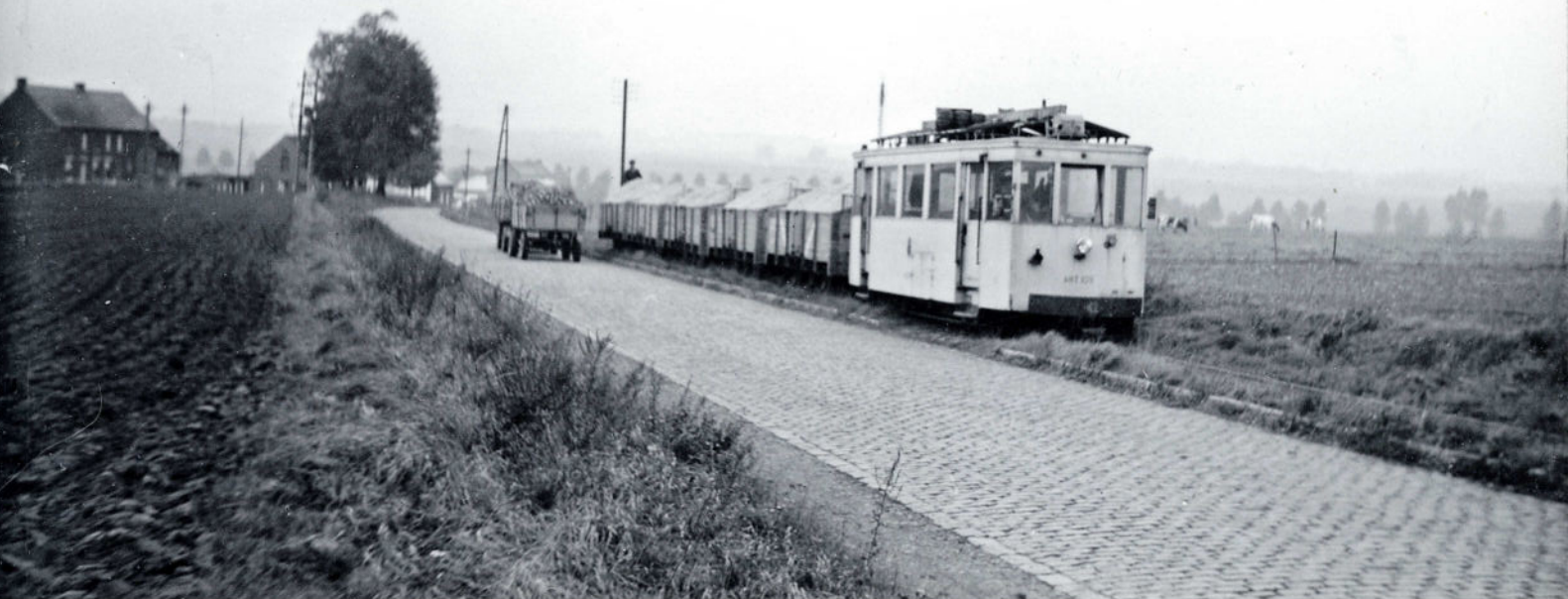
Deze foto dateert van 20 oktober 1960 en werd genomen tussen Quévy en Aulnoye. Het is de periode van de bietenoogst en een zware trein met bietenpulp wordt gesleept door de ART.109. Achteraan, op de laatste wagen, staat een remmer om de handrem te bedienen. De AR.109 kwam op 15 september 1935 in dienst op de lijn Gent - Merelbeke - Herzele - Geraardsbergen. In 1949 werd hij omgebouwd tot ART (autorail tracteur) en toegewezen aan de lijn Mons - Quévy - Aulnoye. Vanaf 1960 werd de ART.109 ingezet voor het bieten-transport naar Quévy-le-Grand. Het voertuig werd in september 1963 uit dienst genomen. H.-G. HESSELINK, verzameling TSP.
