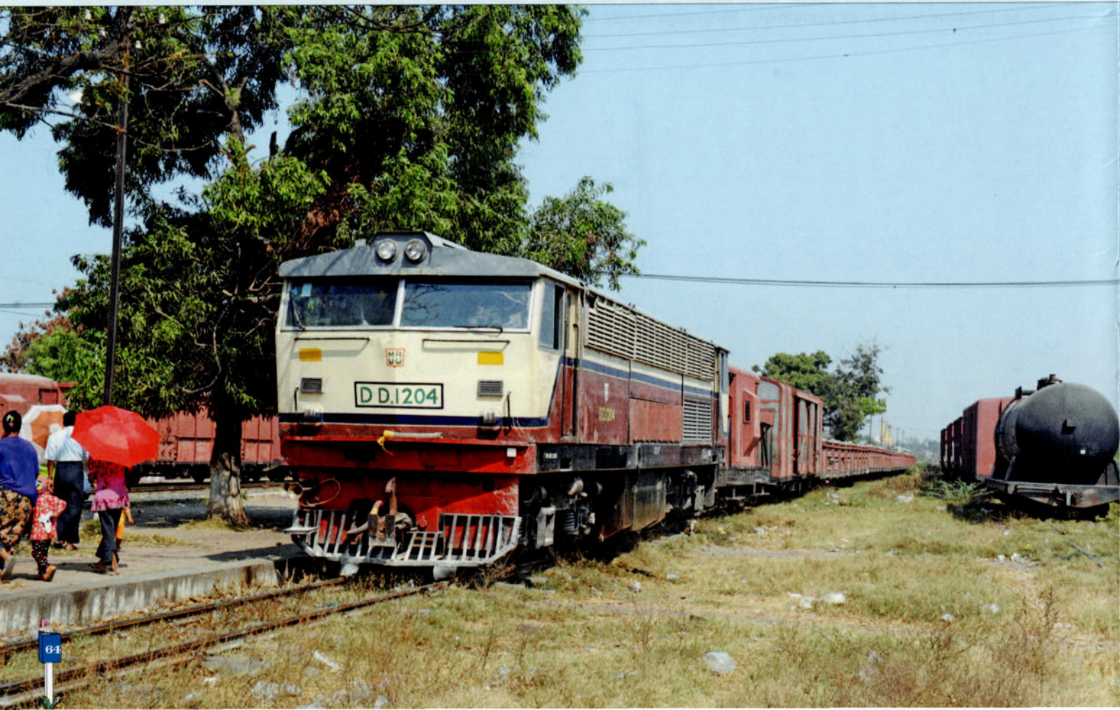
FOTO 134-83 De DD 1204 (DD voor diesellocomotief met vier assen, de machines uit de reeks DF hebben zes assen) wacht op 20 februari 2016 in de vorming van Myo Haung, ten zuiden van Mandalay om haar dienst aan te vatten. Deze locomotievenreeks werd gebouwd door Krupp in 1972 en 1986. Yves STEENEBRUGGEN.
