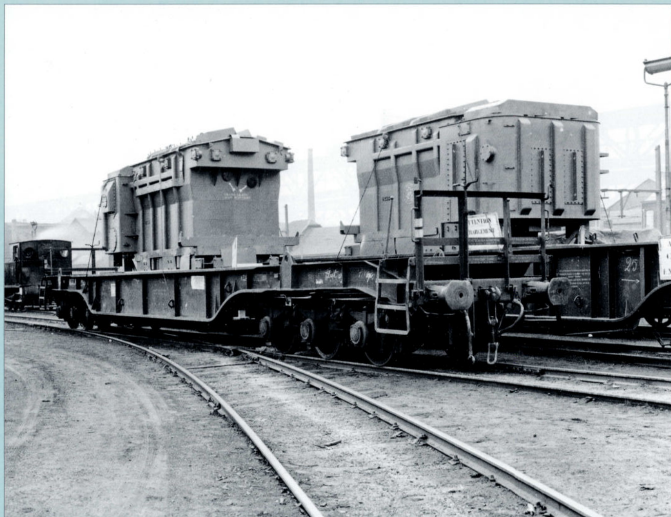
Wagen 377487, beladen met een transformator van ACEC. Marcinelle, 21 januari 1953. De wagen was toen uitgerust met Isothermos-aspotten. Fonds ACEC, verzameling Bois du Cazier
