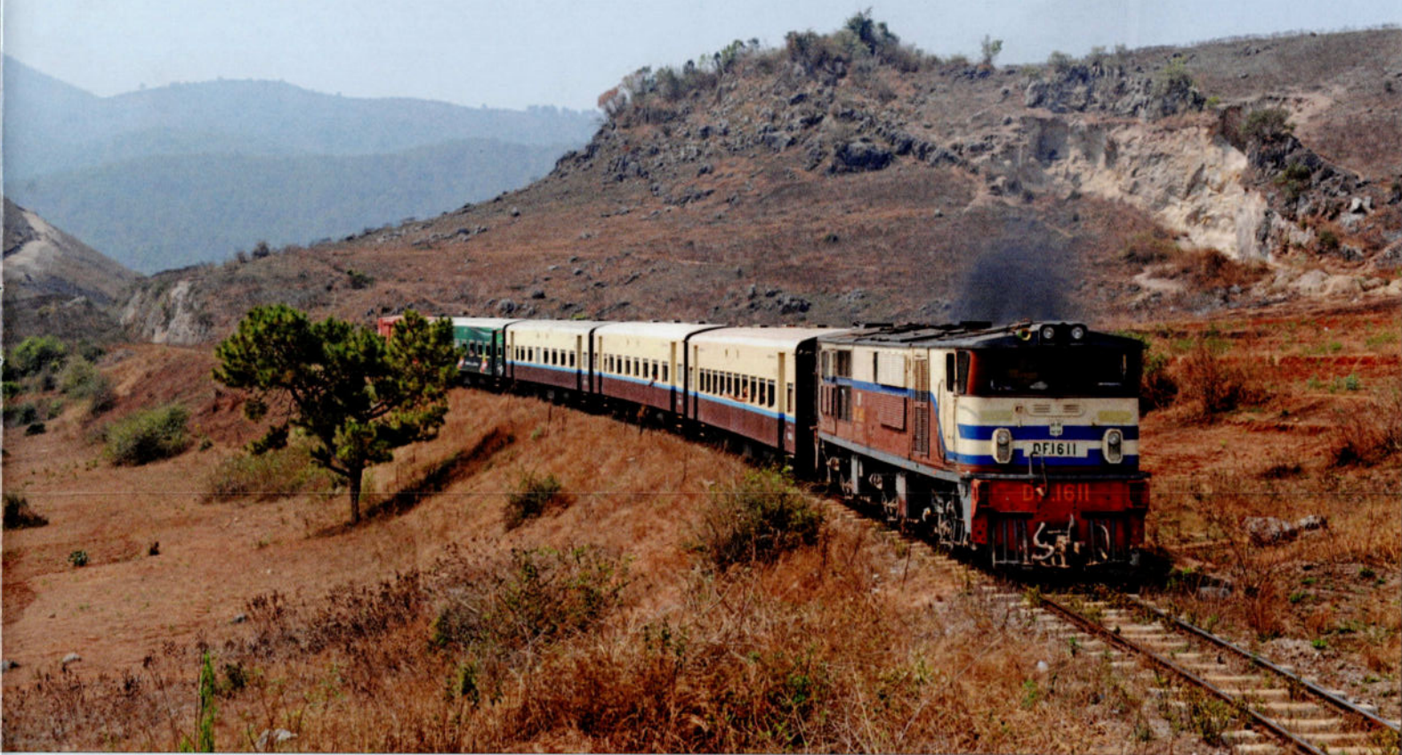
FOTO 134-80 De lijn van Thazi naar het oosten overschrijdt belangrijke hellingen. Bij zeer steile hellingen wordt zigzagsgewijs gereden: de locomotief sleept de trein tot een bepaald punt, duwt hem dan verder omhoog naar een volgend, hoger gelegen haltepunt om hem vervolgens nogmaals een "trapje" hoger te slepen. De DF 1611, met de tweede van drie dagelijkse treinen aan de haak, heeft net deze zone verlaten en begeeft zich naar Aungban, 22 februari 2016. Yves STEENEBRUGGEN.
