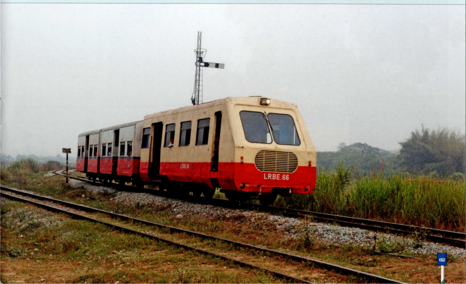
FOTO 134-81 Sommige secundaire zijlijnen worden bereden door LRBE-motorwagens met een zeer geringe capaciteit die zeer kleine tweeassige rijtuigjes slepen. Motorwagen 66 heeft drie assen: twee metalen draagassen voor de geleiding in het spoor en één op luchtbanden voor de aandrijving. Motorwagen LRBE 66 komt aan te Bago op 27 februari 2016. Yves STEENEBRUGGEN.
