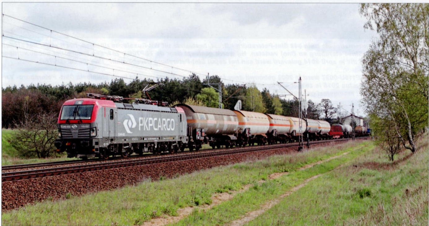
POLEN FOTO 134-61 PKP-Cargo is begonnen met het in dienst nemen van 17 Vectron-locomotieven van Siemens, geklasseerd als type PKP EU46. Dertien van deze machines zullen gebruikt worden voor het verkeer in Polen, Tsjechië, Duitsland, Hongarije en Oostenrijk; de overige vier in Polen, Tsjechië, Slowakije, Duitsland, Hongarije, Oostenrijk en Nederland. Op 16 april 2016 rijdt een trein, gesleept door de EU-46-502 (193 512), voorbij Otusz. Michel HANSSSENS.
