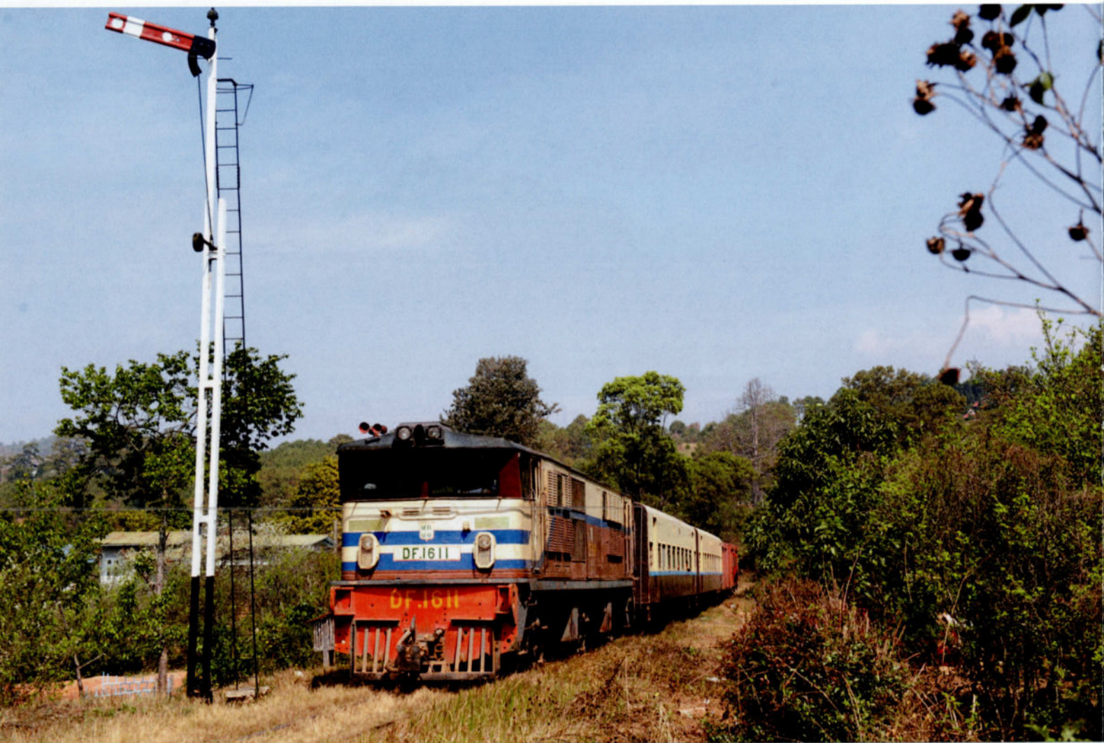
FOTO 134-82 De seininrichting op de secundaire lijnen is overwegend mechanisch. Het uitrijsein van Kallaw geeft aan dat de reisweg voor de DF 1611 vrij is om naar Thazi te rijden. 21 februari 2016. Martin HÄFLIGER.
