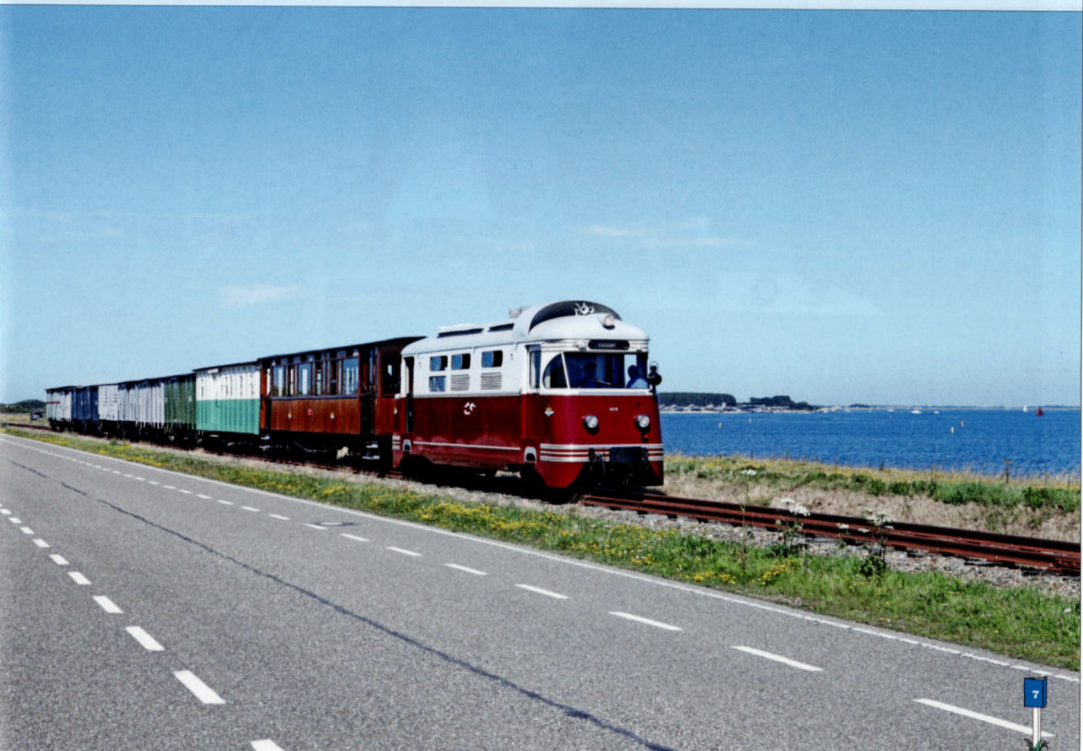
FOTO 135-06 Onze goederentrein gefotografeerd op één van de afsluitdijken. Hij wordt gesleept door motorwagen MD 1805. Dit voertuig werd in 1952 gebouwd door de N.V. Carrosseriefabriek "Hoogeveen" en de werkplaats van de RTM op een chassis dat uit 1913 dateert. TSP.
