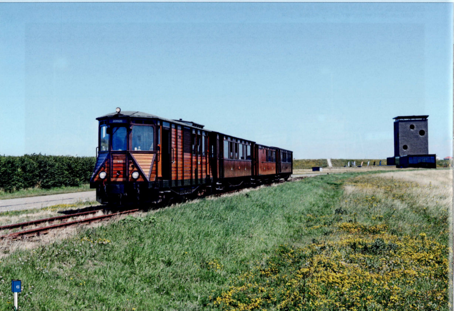
FOTO 135-04 Onze eerste speciale trein werd gesleept door dieselmotorwagen M67. Hij bestond uit de rijtuigen AB 394 + BD 438 (gebouwd in België in 1898 door "La Métallurgique") en de AB 398. Deze motorwagen met een volledig houten kast werd in 1949 gebouwd door de werkplaats van de RTM. De trein werd gefotografeerd tijdens een fotostop te Port Zélande. TSP.
