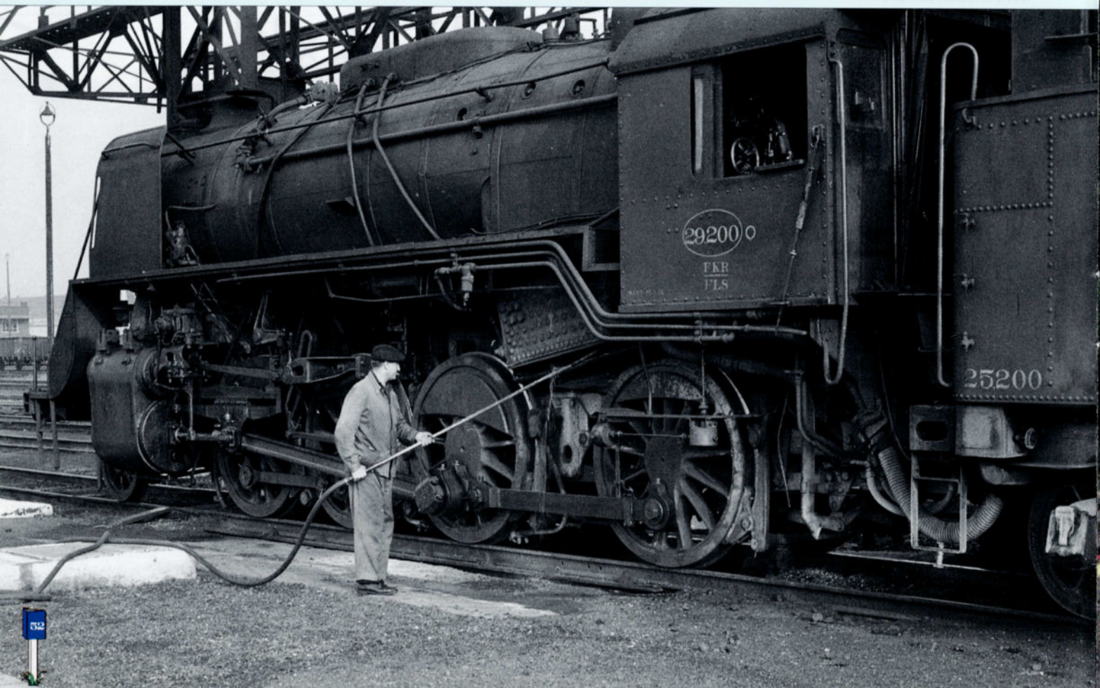
FOTO 136-48 ↑ - FOTO 136-49 ↓ Op 10 september 1966 wordt de 29.200 van de stelplaats Aalst te Kortrijk klaargemaakt voor de terugrit: er wordt water genomen en het rooster wordt gereinigd. Nog enkele weken, dan behoort dit beeld definitief tot het verleden. De 29.200 werd gebouwd door de Canadian Locomotive Company (nr. 2327) en ving haar loopbaan aan bij de stelplaats Ottignies op 20 augustus 1946. Daarna was de machine gestationeerd te Kortrijk (12-06-1957), Ronet (27-02-1958), Bertrix (24-11-1958), Latour (27-09-1963), Ronet (15-01-1965) en ten slotte Merelbeke (02-02-1966), waar haar loopbaan eindigde bij de ondergeschikte stelplaats Aalst. Ze werd in reserve geplaatst en op 6 februari 1967 nog gemuteerd naar Leuven. Op 20 april 1967 werd zij definitief buiten dienst gesteld. Foto's Hugo NAUWELAERTS, verzameling TSP.
