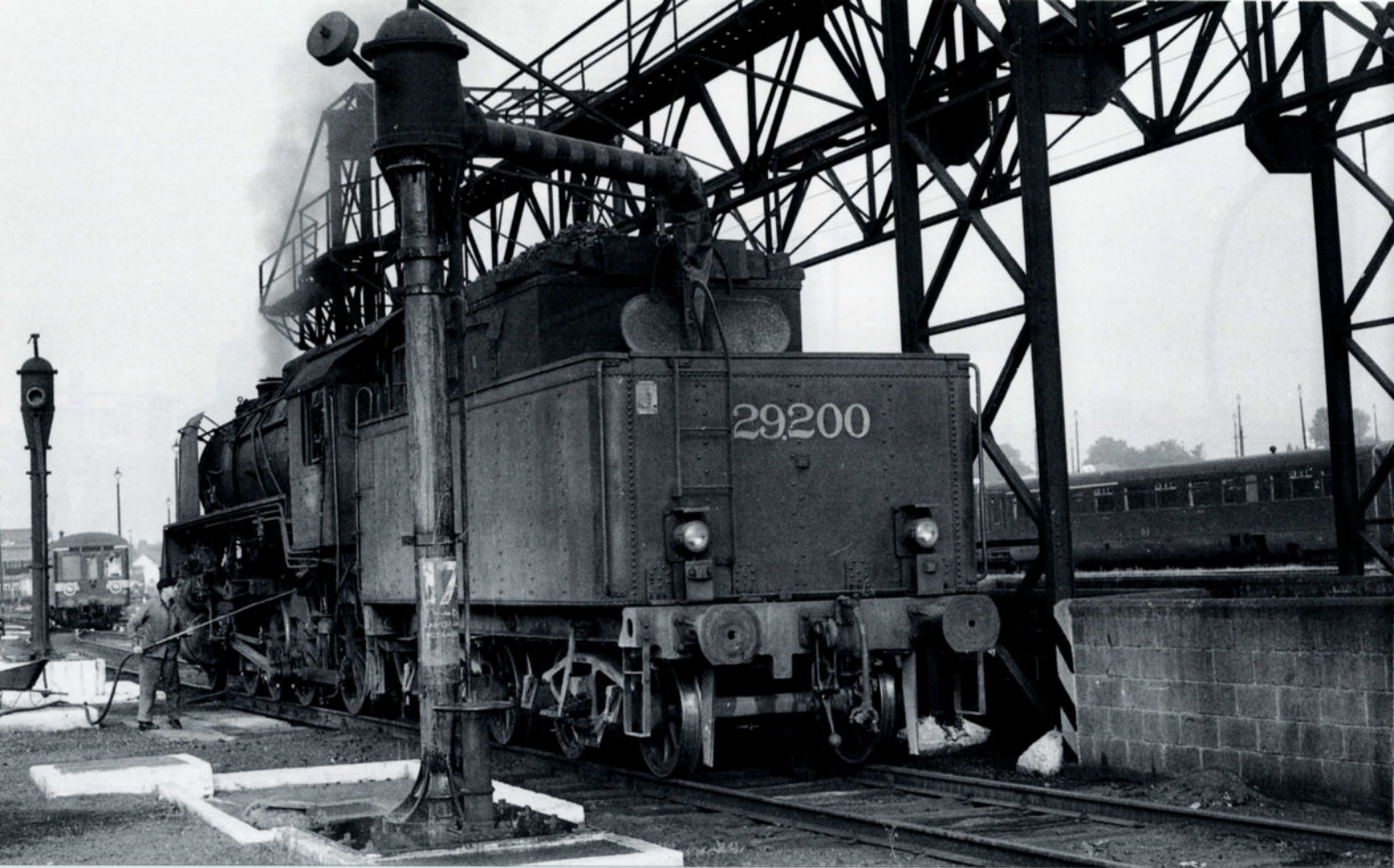
FOTO 136-48 ↑ - FOTO 136-49 ↓ Op 10 september 1966 wordt de 29.200 van de stelplaats Aalst te Kortrijk klaargemaakt voor de terugrit: er wordt water genomen en het rooster wordt gereinigd. Nog enkele weken, dan behoort dit beeld definitief tot het verleden. De 29.200 werd gebouwd door de Canadian Locomotive Company (nr. 2327) en ving haar loopbaan aan bij de stelplaats Ottignies op 20 augustus 1946. Daarna was de machine gestationeerd te Kortrijk (12-06-1957), Ronet (27-02-1958), Bertrix (24-11-1958), Latour (27-09-1963), Ronet (15-01-1965) en ten slotte Merelbeke (02-02-1966), waar haar loopbaan eindigde bij de ondergeschikte stelplaats Aalst. Ze werd in reserve geplaatst en op 6 februari 1967 nog gemuteerd naar Leuven. Op 20 april 1967 werd zij definitief buiten dienst gesteld. Foto's Hugo NAUWELAERTS, verzameling TSP.
