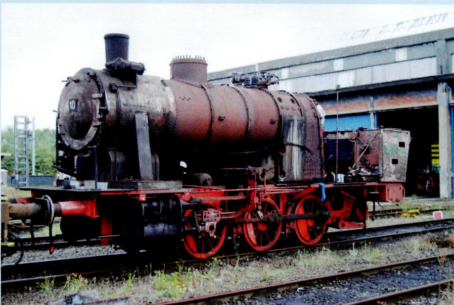
Te Schaarbeek werd de ketel van onze "Knapsack" ontdaan van al zijn toebehoren. Elk element werd zorgvuldig gerestaureerd en genummerd in afwachting van het herplaatsen. De keuring van de ketel kan nu gebeuren en is gepland voor de maand november. TSP.
