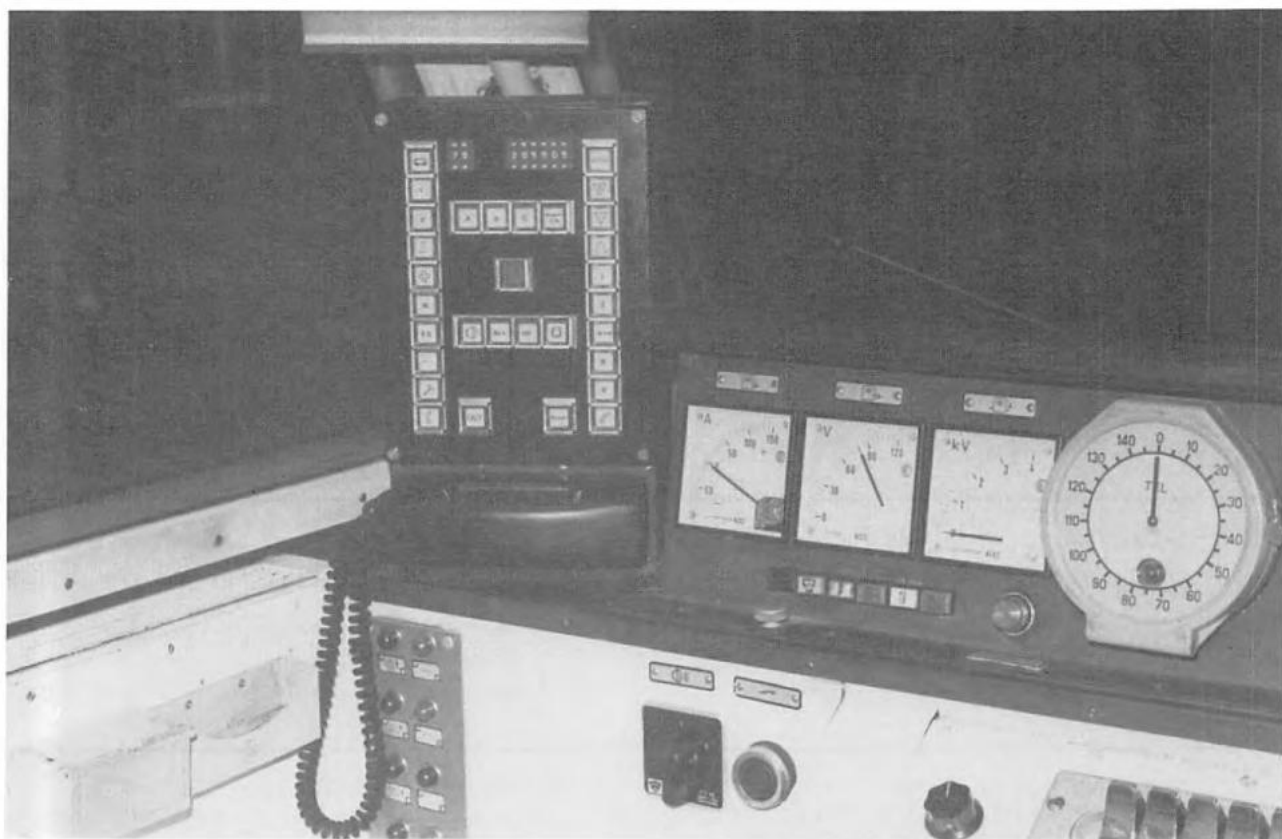
In de stuurposten van de oranje-grijze "viertjes" beschikken de bestuurders over een rechtstreekse radioverbinding met de vaste wal. Merk het bedieningskastje links. (foto Mahieu Jan -28/11/83-AM839).
