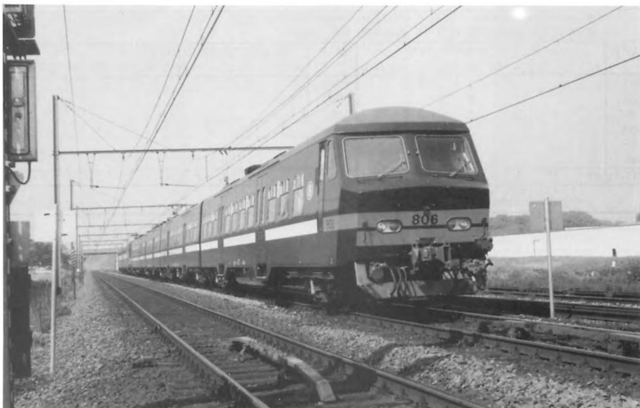
Het stel 806 (in de nieuwe IC-IR kleuren) tijdens proefrit voor het afstellen van het TBL (transmission balise locomotive) - systeem. (+AM753). fto: Aarschot 03.07.1985 (jm).
