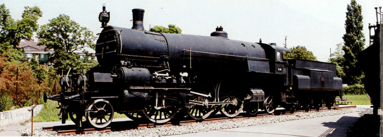
Afbeelding 5: De 16.08 (voormalige 310.23, bouwjaar 1911), de legendarische 1 C 2-h 4 v van de beroemde constructeur Gölsdorf. Na een complete opknappbeurt in de hoofwerkplaats Knittelfeld zal ze er in 1987 weer onder stoom komen. Foto: K. Pfeiffer
