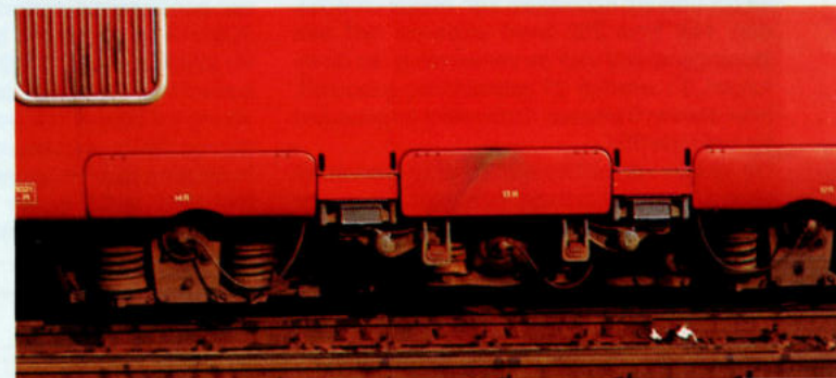
Afbeelding 17: Ter vergelijking met de linker afbeelding het aangedreven draaistel van de originele motorwagen.
