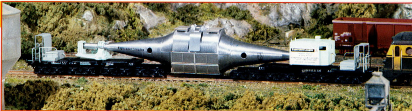
Op deze foto ziet U een fraai model van Dacker van een „Torpedo-Thermos“-wagen bestemd voor het transport van vloeibaar gietijzer. Dit model is één van de 300 exemplaren die Dacker met certificaat levert.
