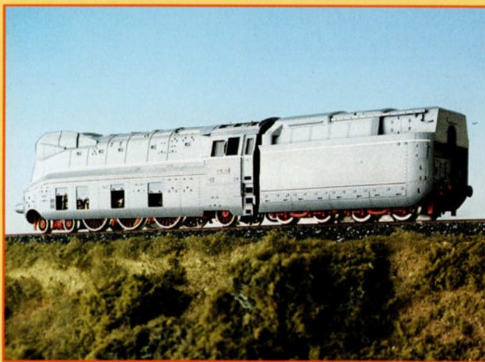
De BR 03.10 van Fleischmann in HO met geopende rolluiken bij het drijfwerk.
