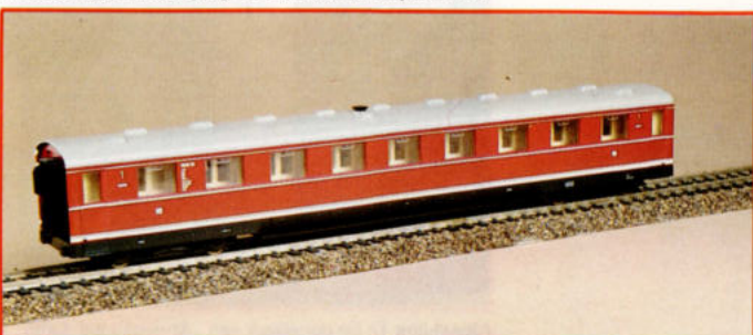
Afbeelding 10: Tussenrijtuig van de VM 06 104 met de nieuw ontwikkelde koppeling.
