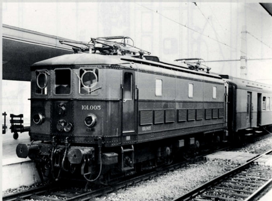
2. De 101.005 in Brussel-Noord. Deze foto toont duidelijk zowel de kontaktdozen voor de meervoudige traktie als de tweetonengroene schildering. Foto: P.S. Postma
