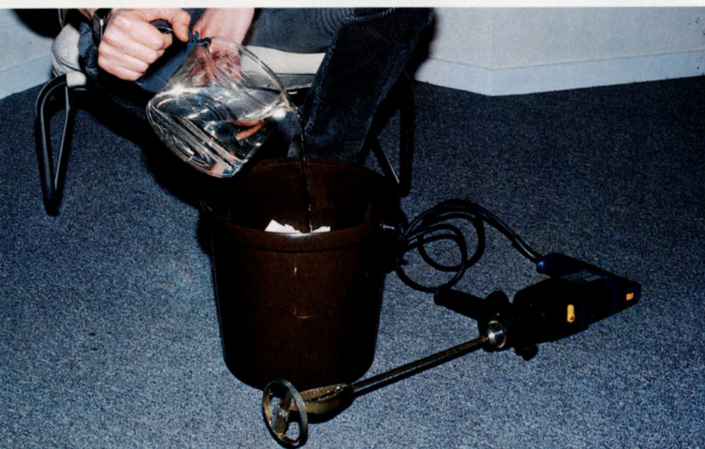
2. Als de emmer voor ongeveer tweederde deel gevuld is met het krantenpapier, wordt warm water toegevoegd. Foto : H.K.
