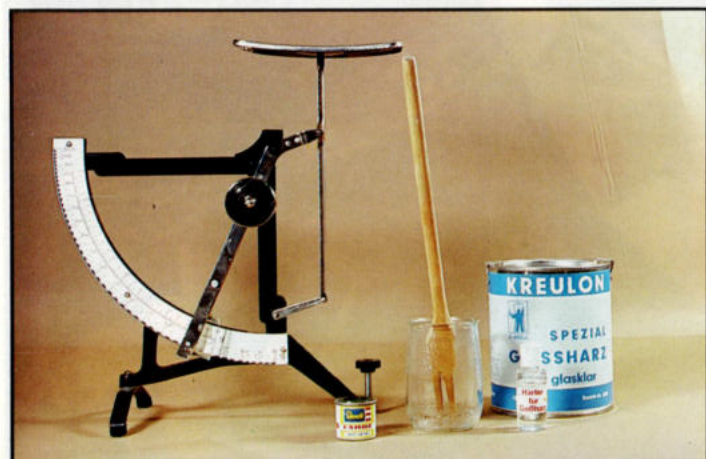
8. Giethars en harder moeten exact volgens de specificatie van de fabrikant worden gemengd. Enige druppels verf toevoegen om een beetje kleur in de hars aan te brengen.
