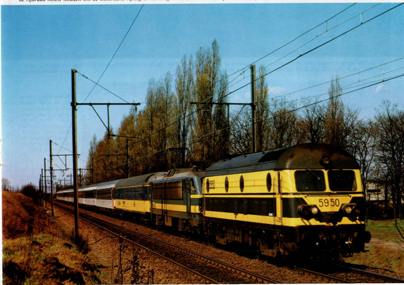
18. Op 5 april 1987 lieten de kompressoren van de lokomotief 2119 het afweten zodat er geen perslucht voor de remmen voorhanden was. De 5950 van Antwerpen-Dam werd ingeschakeld om de E 284 veilig van Essen naar Brussel-Noord te slepen. Bijzonder aan deze opname is wel dat de 2119 zijn pantograaf tegen de rijdraad moest houden om de elektrische rijtuigverwarming te verzekeren. Deze opname werd gemaakt te Mortsel. Foto : Max Delie.
