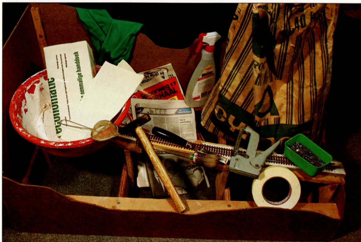
1. De belangrijkste benodigdheden voor het aanbrengen van een hard shell landschap op een LOR zijn oude kranten (of tijdschriften!), modelgips, papieren handdoekjes en plakband. Naast wat gereedschap zijn verder alleen nog een dosis moed en gezonde zelfkritiek nodig om een realistisch basislandschap te verkrijgen. Het hoe en waarom vindt U in deze VAKWERK aflevering.
