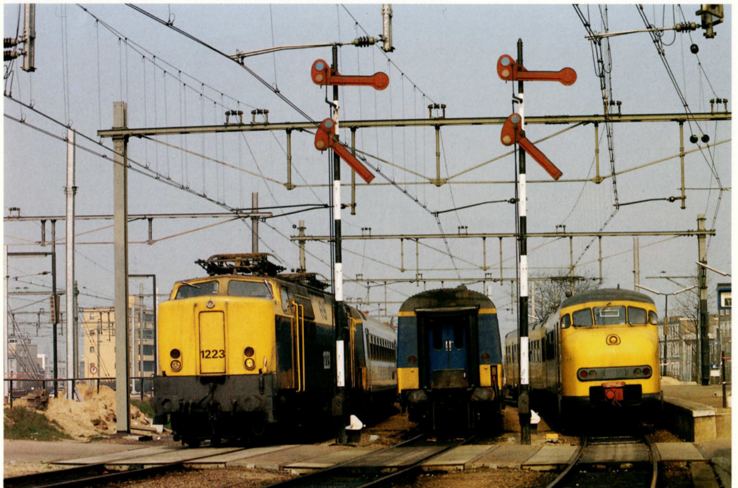
5. Stoptonende seinen voor de oude beveiliging van Venlo, die per 23 oktober 1988 werd vervangen door een modern systeem met lichtseinen. Op de foto staan E-loc 1223 voor trein 2509 en het treinstel Plan V Elp2 938 (als trein 1540), 07-08-'88. Foto : Wim Verver
