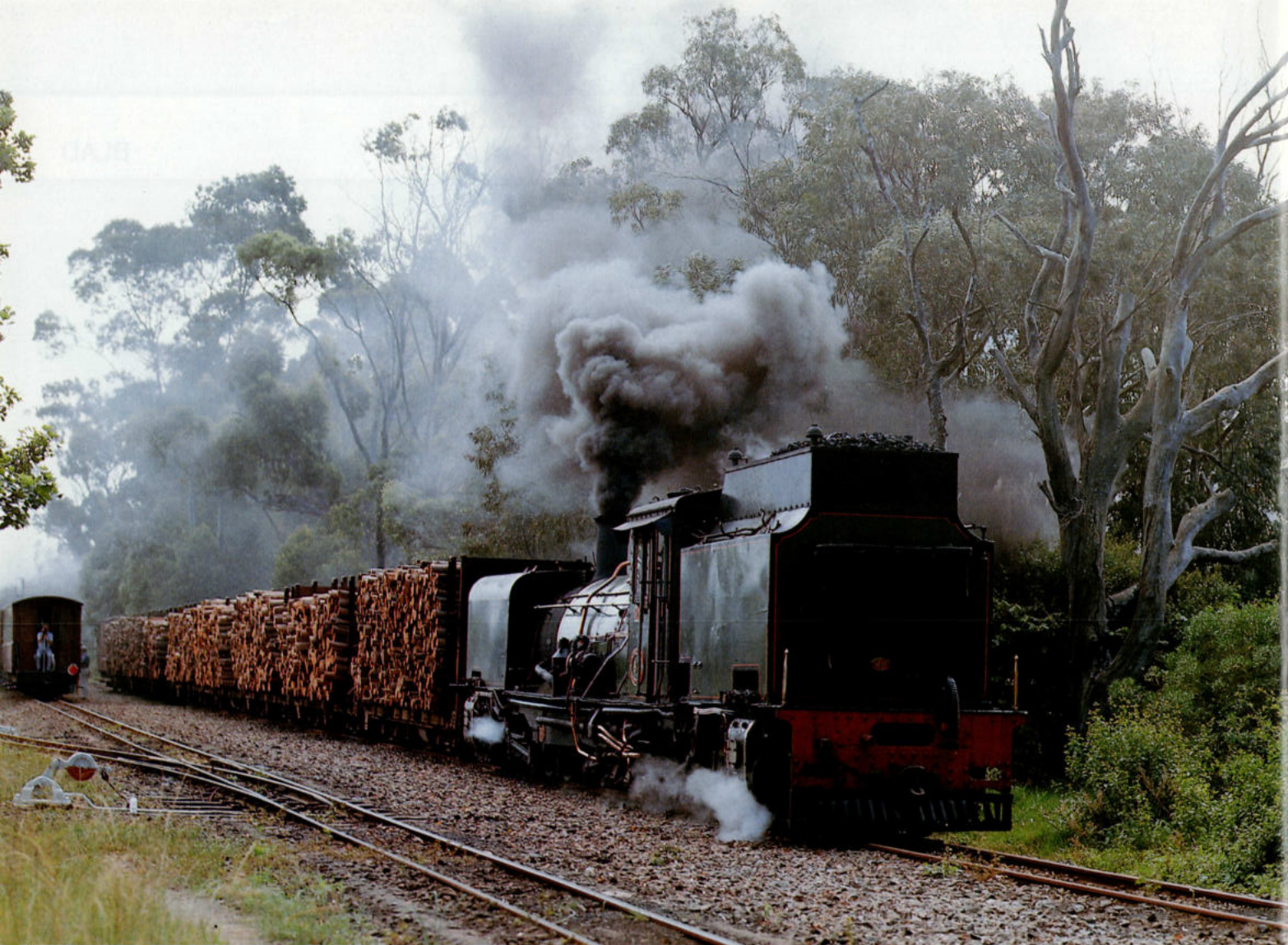
1. De in 1934 door Cockerill gebouwde Garratt voor 610 mm spoor is nog steeds in dienst bij de „Alfred County Railway” in de provincie Natal, Zuid-Afrika. De lok vertrekt met een lading hout voor Port-Shepstone uit het station van Izotscha op 1 april 1988. Foto : Max Delie
