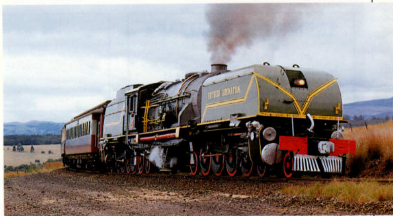
6. Twee GF-Garratt's plus een type 19B, trekken de speciale trein van de Zuidafrikaanse spoorwegvrienden op de privé-spoorweg van de Enyati-koolmijn. Van de GF-Garratt's werden 65 stuks gebouwd in de jaren 1927-1928 door Hanomag, Maffei en Henschel. In 1979 werden ze door de Zuidafrikaanse spoorwegen buiten dienst gesteld. Door de Amocoal Collieries Ltd werden 5 stuks aangekocht voor de Enyati-spoorweg. Ze zijn nog steeds in dienst. Foto : Max Delie, 3 april 1988.
