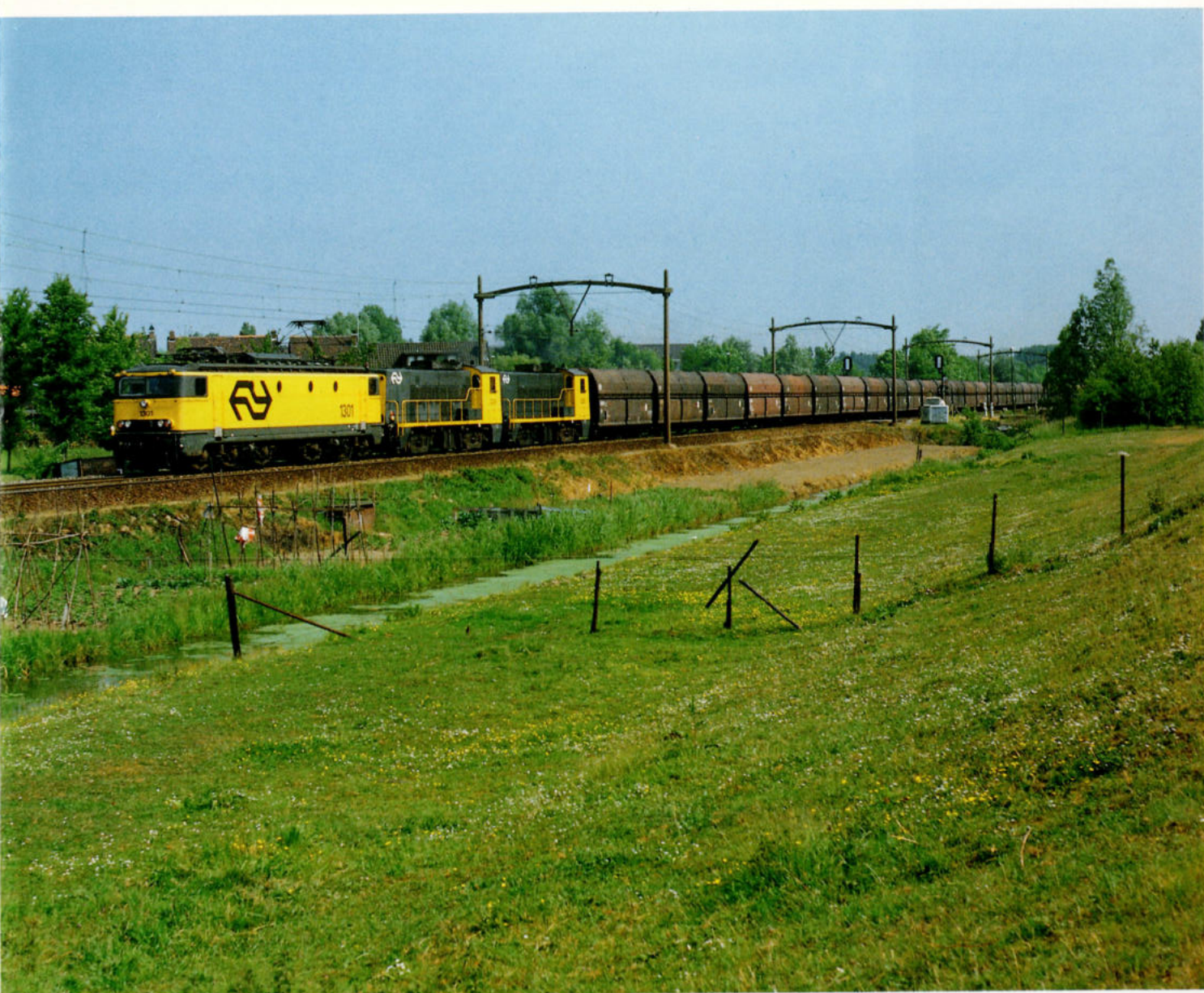
15. Om een tekort aan vermogen van de E-loc, bij aanzetten en bij inlopen van eventuele vertragingen, op te vangen wordt bij de 4000 tons ertstreinen van Rotterdam naar Duitsland gebruik gemaakt van gemengde tractie. De diesellocs leveren alleen maar vermogen bij het aanzetten en onderweg als de machinist van de E-loc er om vraagt. Via een intercomverbinding doet hij dan een verzoek aan de meester van de diesellocs om „power“ bij te leveren. Veelal werden deze treinen door 1600'en gereden, maar begin 1988 kwam ook de serie 1300 door zijn hogere adhesiegewicht veel voor deze trein voor. De foto toont 1301 + 2339 + 2230 met een trein naar Emmerich bij Dordrecht Zuid, 26-05-'88. Foto : F.J. Janssen
