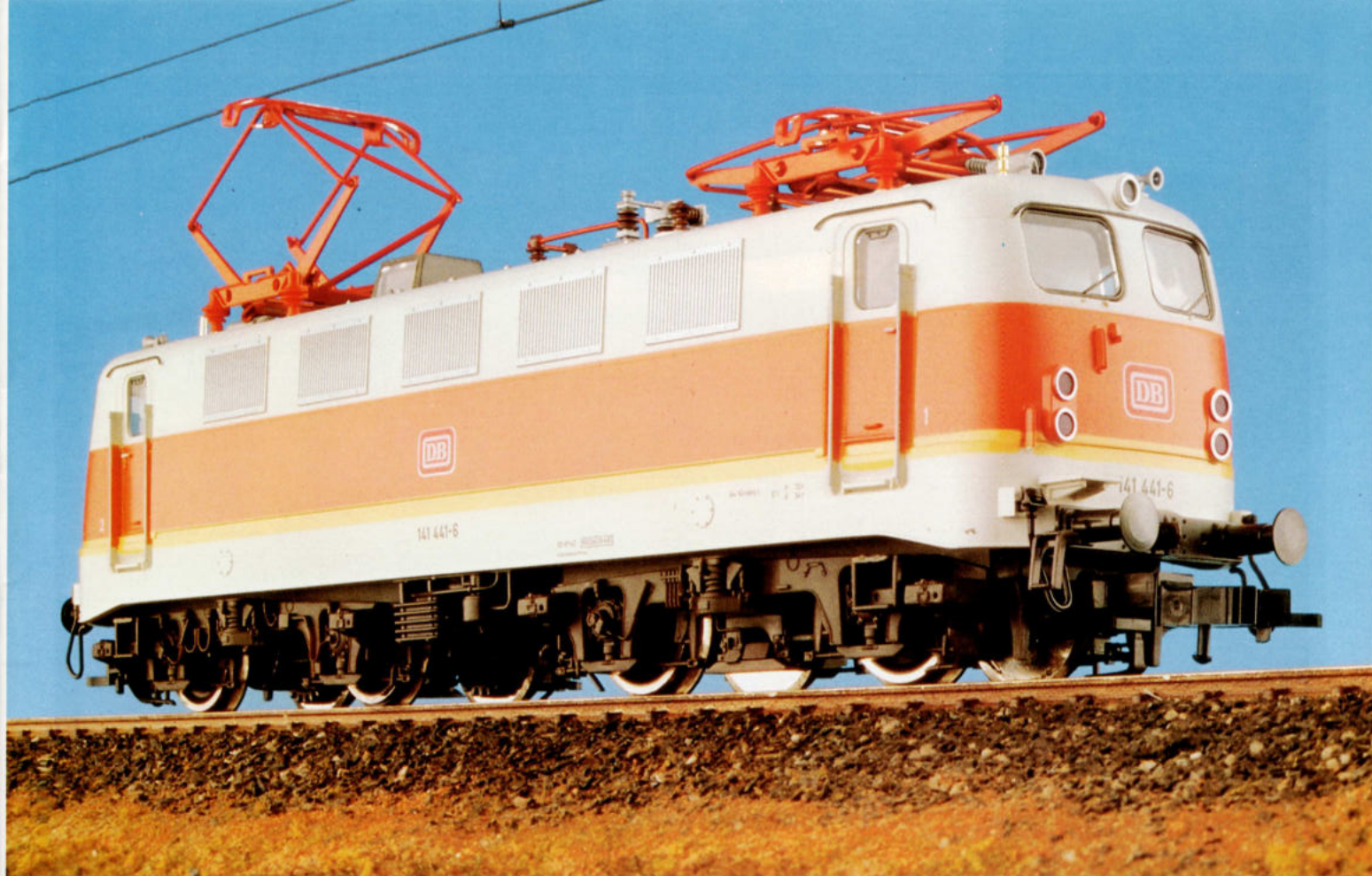
3. FLEISCHMANN's S-Bahn E-loc 141 in de aktuele kleuren is een exacte kopie van het origineel van het depot Neurenberg 1. Alle maten komen overeen met de schaal 1 :87.
