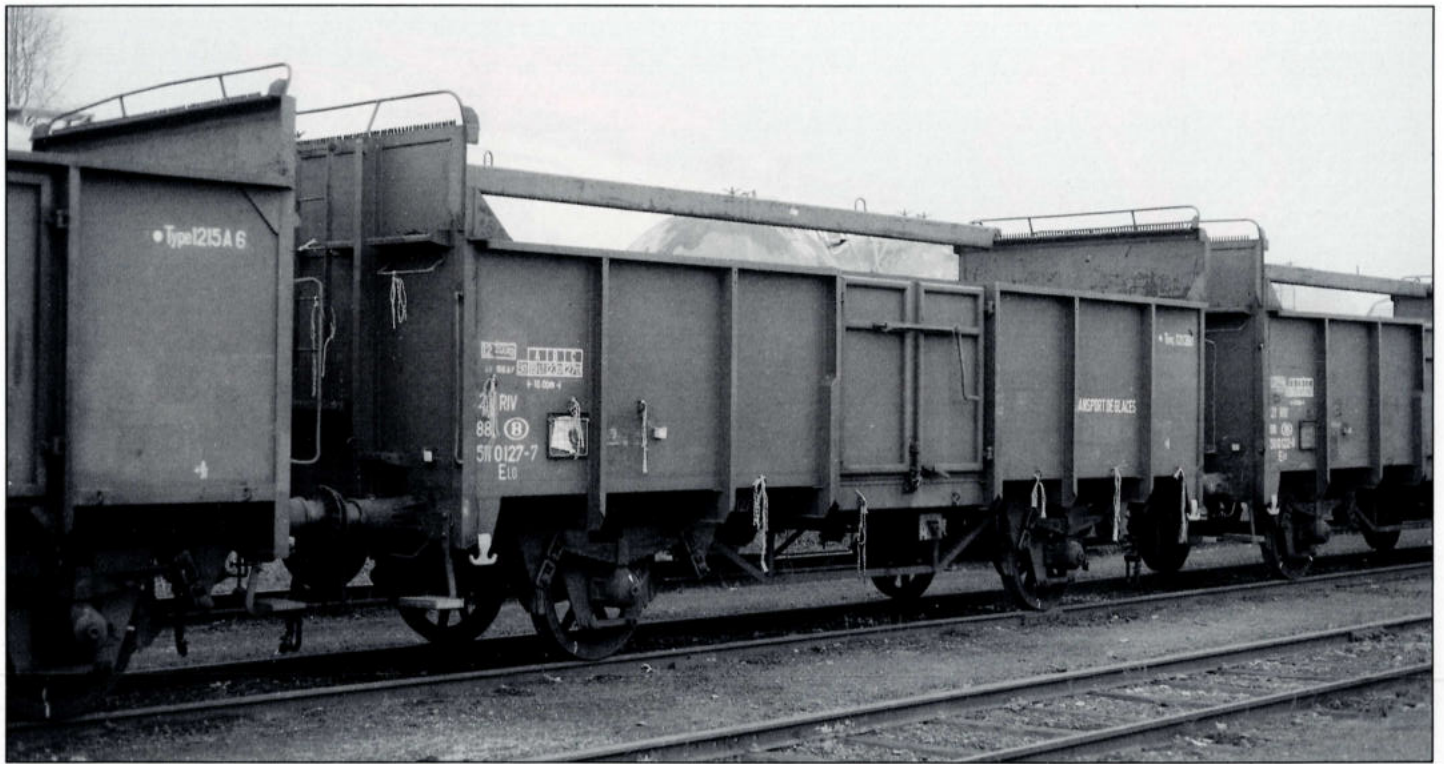
1. Wagon van het type ELO zoals de NMBS en de firma GLAVERBEL die met name voor 't transport van ijs en glas gebruiken.
