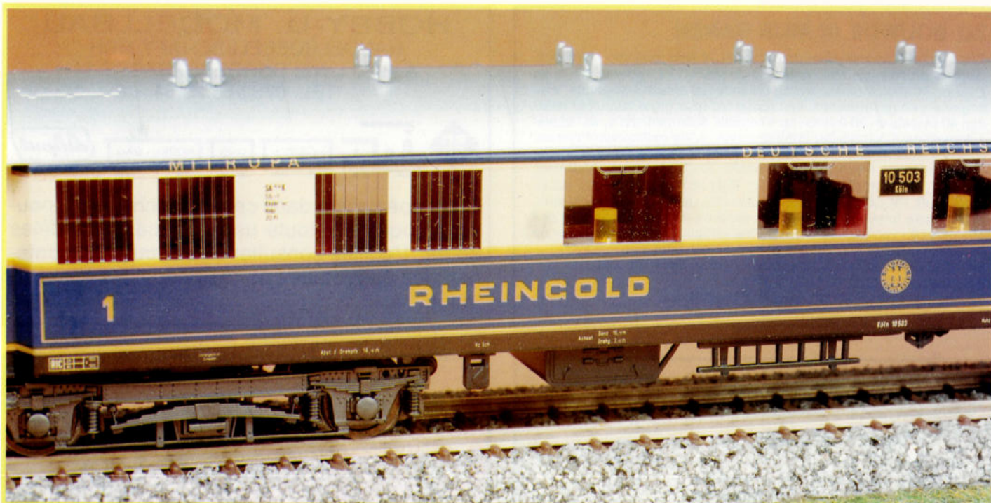
9. Als imitatie voor de schemerlampjes op de tafeltjes in de „Rheingold” dienen dioden. Zij branden reeds op volle sterkte bij een geringe spanning.
