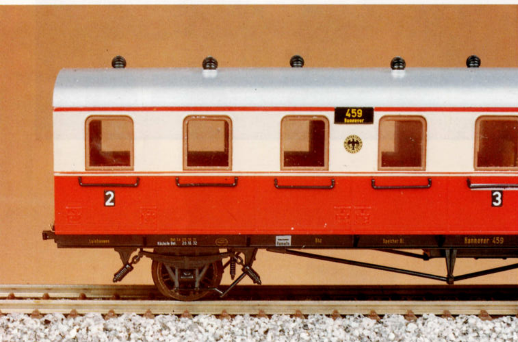
3. Zeer fijn uitgevoerd zijn de aslagers en de veren.
