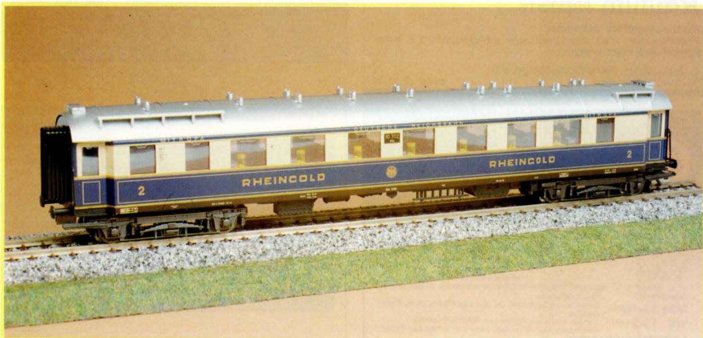
10. Voor de vervaardiging van deze „Rheingold” rijtuigen heeft MÄRKLIN gebruik gemaakt van een oude produktietechniek in moderne vorm. De rijtuigen zijn van lithografisch bedrukt metaal gemaakt.
