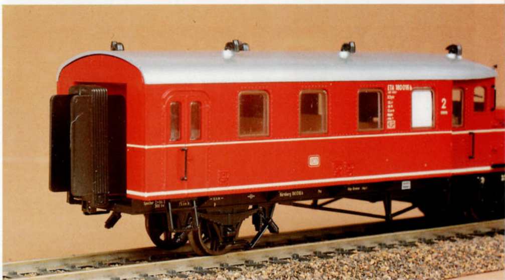
6. De imitatie harmonikaverbinding, samen met de stroomvoerende kortkoppeling bij het treinstel in de uitvoering van de DB.
