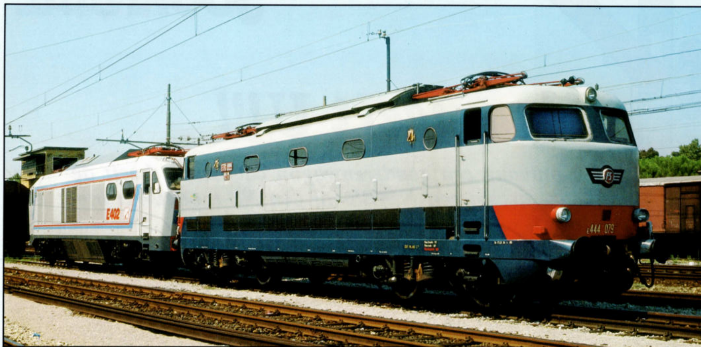
6. Een E 444 van de tweede bouwserie, een TARTARUGA. Dit waren de eerste moderne locomotieven van de FS geschikt voor 200 km per uur. Op de foto trekt een E 444 079 zijn toekomstige vervanger : het prototype E 402. Foto : Giorgio Strini
