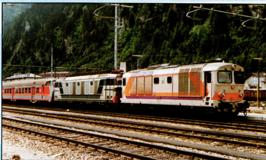
6. Een E 444 van de tweede bouwserie, een TARTARUGA. Dit waren de eerste moderne locomotieven van de FS geschikt voor 200 km per uur. Op de foto trekt een E 444 079 zijn toekomstige vervanger : het prototype E 402. Foto : Giorgio Strini
