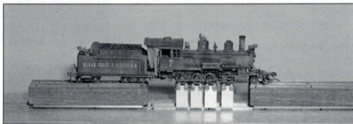
11. Het testen en inrijden van het frame met aandrijving gaat uitstekend met een rollentestbank. Hier gaat het om een zelfgebouwd model, maar er zijn ook commerciële types verkrijgbaar. Het gedrag van de loc in wisselstraten en op kruisingen kan hiermee uiteraard niet bepaald worden en dus is altijd nog een uitgebreide testrit op de baan nodig. Alle foto's : Ronald Koppen
