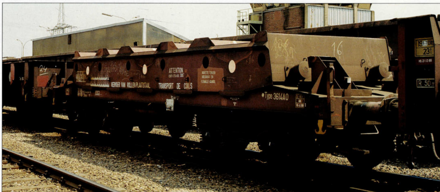
1. Prototype van een wagon voor het vervoer van coils op mobiele onderstellen 3614 AO. Dit unieke model draagt als nummer UIC 3188476 4 000en werd in 1966 gebouwd op gelaste Y 25 draaistellen. Jammergenoeg is 't bij één exemplaar gebleven.
