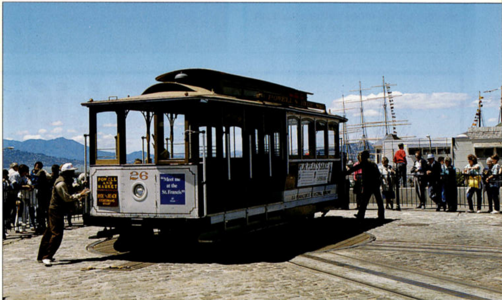
3. Op het eindpunt van de Powel & Hyde lijn te „Fisherman's Wharf” worden de wagens met mankracht gedraaid. Alle foto's: Max Delie
