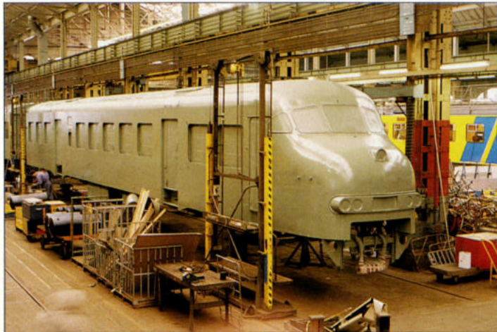
2. Bk 436 is in Lichte rij 2 met roestwerende epoxy-primer behandeld en staat nu in de „Grote Herstelling“, 16-03-'89.
