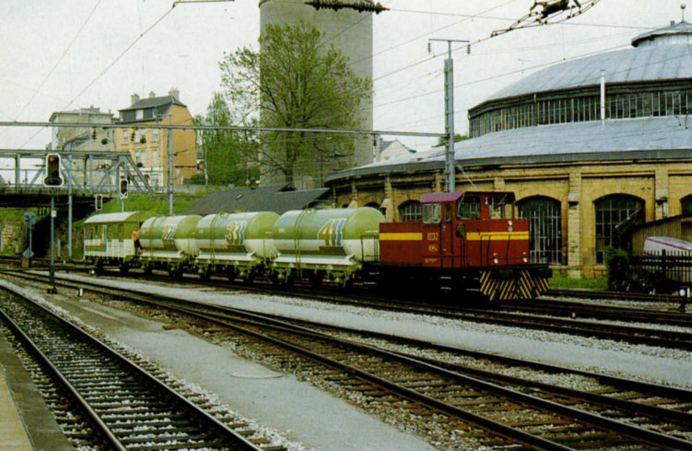
5. Jenbach-loc 1032 met de nieuwe sproeitrein, die in de werkplaats Ptange werd gebouwd, te Luxemburg station. De pakwagen bevat de compressor en de sproeikoppen, 09-05-'88. Foto: Cor Dijkshoorn
