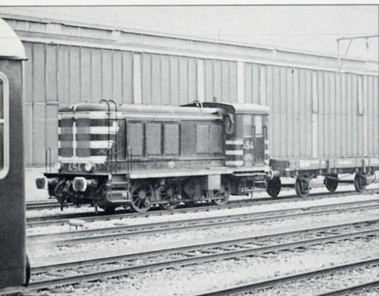
5. Jenbach-loc 1032 met de nieuwe sproeitrein, die in de werkplaats Ptange werd gebouwd, te Luxemburg station. De pakwagen bevat de compressor en de sproeikoppen, 09-05-'88. Foto: Cor Dijkshoorn
