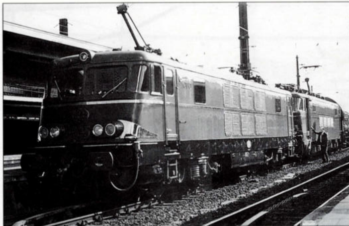
2. Een loc reeks 15 komt hier de 1602 ter zijde staan, aangezien het gewicht van de te trekken last de 750 ton overschrijdt. Foto: R.Visser
