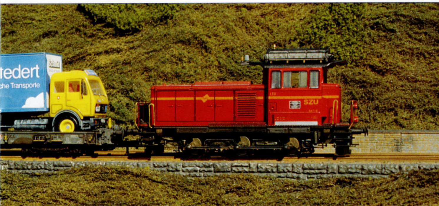
5. Een rangeerlocomotief Em3/3 aan het werk met twee Saadkms-wagons, teneinde een "rollende autoweg"-trein samen te stellen. Foto: D.P.
