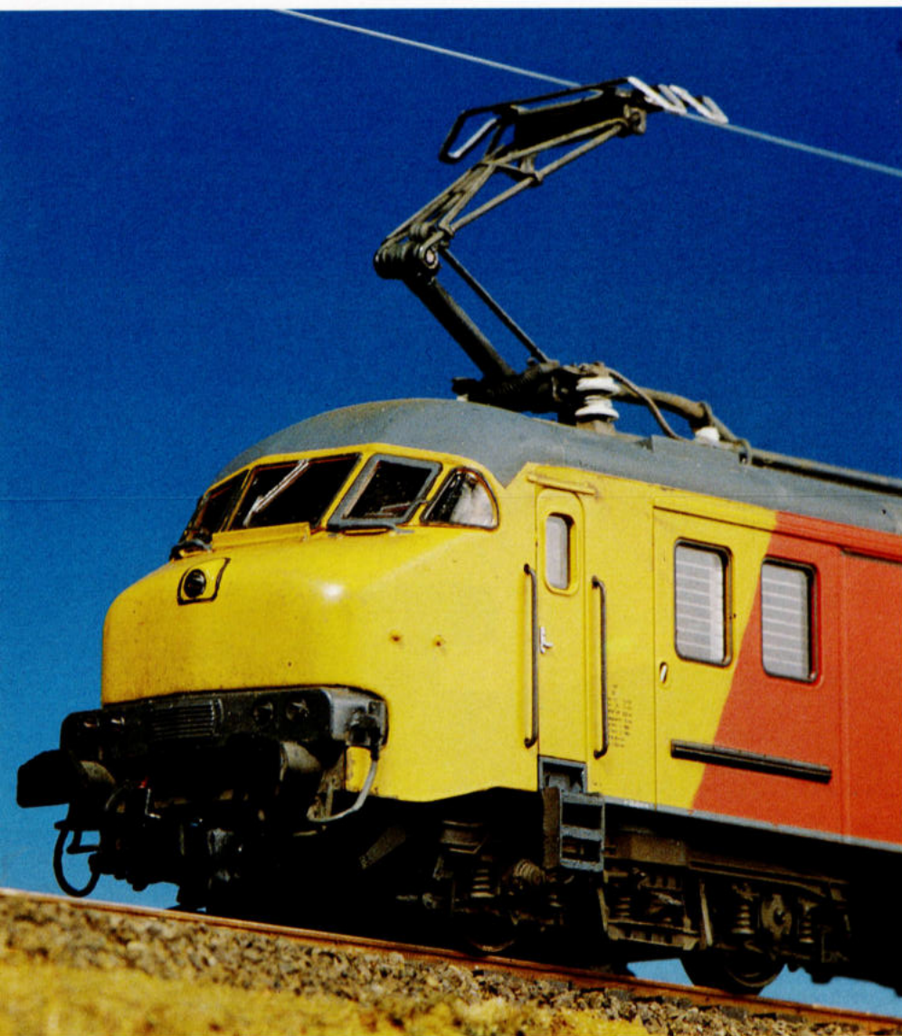
4. (Detail van de kop.) Op deze foto is de kleur heel goed zichtbaar. Let ook op de baanruimers met ATB spoelen op de draaistellen. Foto: H.K.
