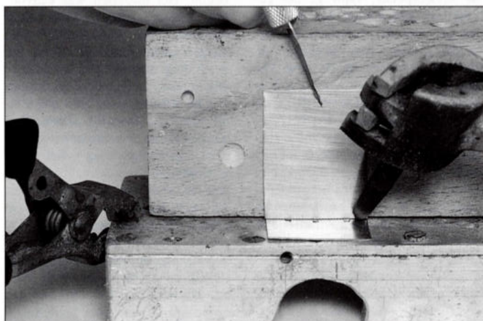
4. Hier wordt met twee stukjes messingplaat geoefend voor het samenvoegen van wanden met een weerstandsoldecrapparaat. Eén wand ligt vlak op de aardeplaat, de tweede wand wordt haaks recht op gehouden tegen een blokje hout. Er zijn flux en kleine stukjes geplet soldeer aangebracht en de kooelelektrode staat klaar.
