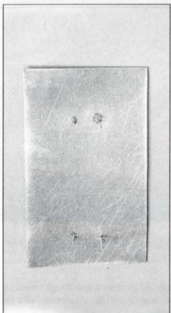
7. Bij het solderen van handgrepen is een minimale hoeveelheid soldeer nodig. Wanneer u de foto goed bestudeert, ziet u dat bij één van de oefen-handgrepen twee stukjes soldeer van ca. 0.5 mm 2 klaarliggen. De andere is al gesoldeerd en een schone, maar stevige verbinding is het resultaat.
