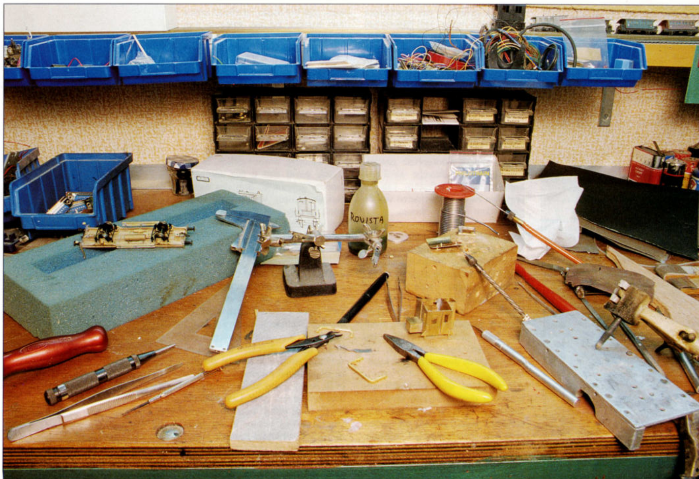
3. Een foto van de werktafel na afloop van het project, geeft een goede indruk van het gebruikte gereedschap en de toegepaste hulpmiddelen. Messing bewerken is niet veel moeilijker dan het bouwen in styreen of hout, maar met name het solderen vraagt wat oefening.
