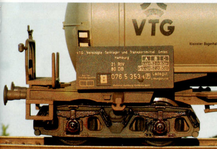
7. De draaistellen worden eerst matzwart geschilderd en krijgen daarna nog een likje verf in een "vuil"-tint. Foto: D.R.
