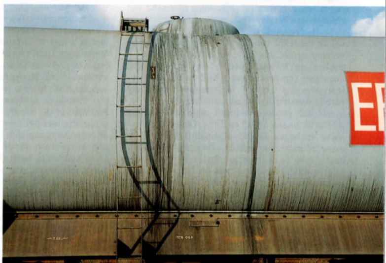
6. Op dit voorbeeld zijn de sporen van het overlopen van de ketel duidelijk te zien. Foto: D.R.
