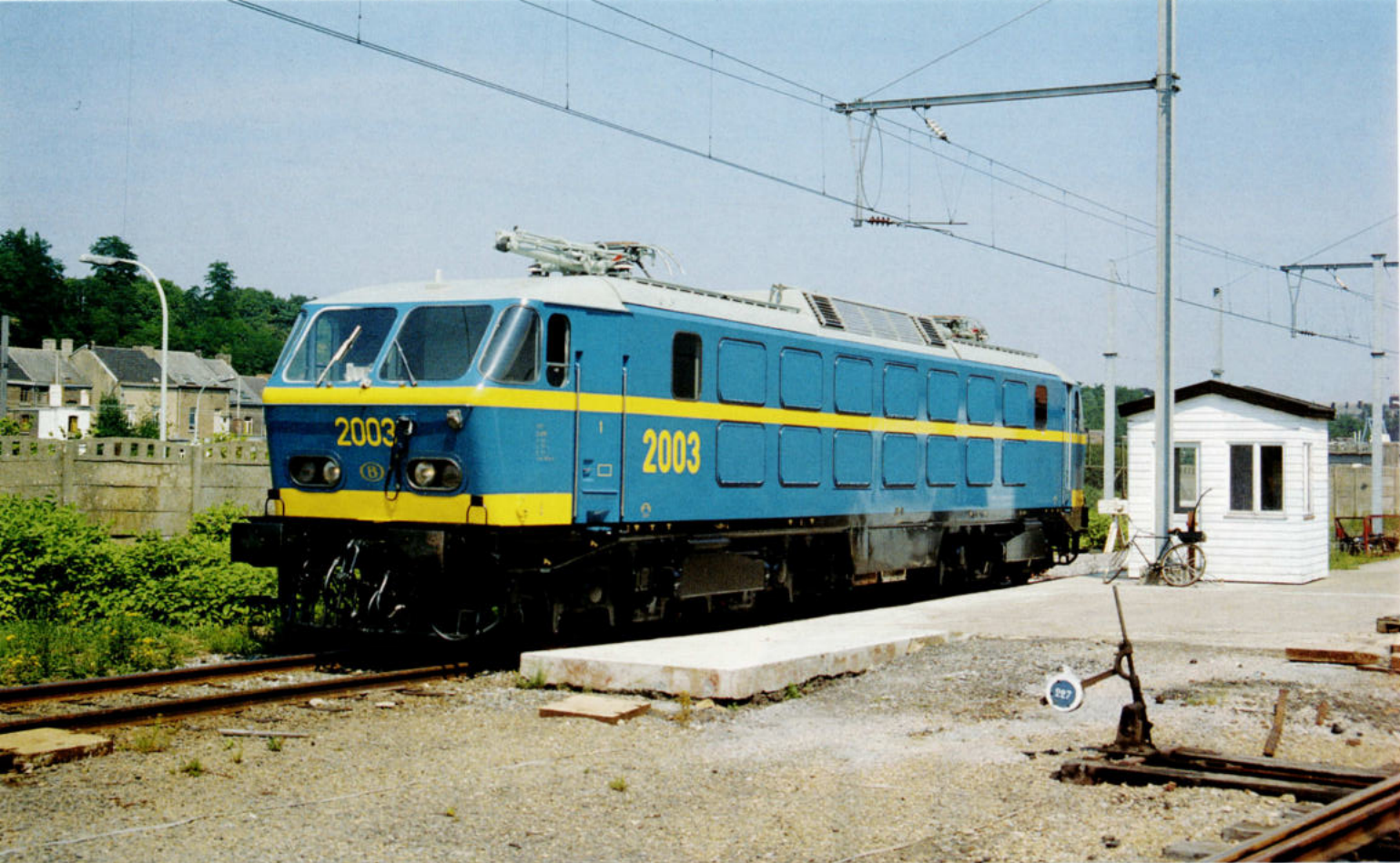
7. Sprankelend in de zonnestralen: de 2003 op het testspoor na zijn grote herziening. Bemerkt de ongewone afmetingen van de isolatoren, daar de bovenleiding ook kan gevoerd worden onder 25 kV 50 Hz, 20-07-1990.
