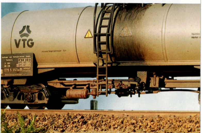
8. Bij de uitlaatkraan zien we sporen van olie. Foto: D.R.
