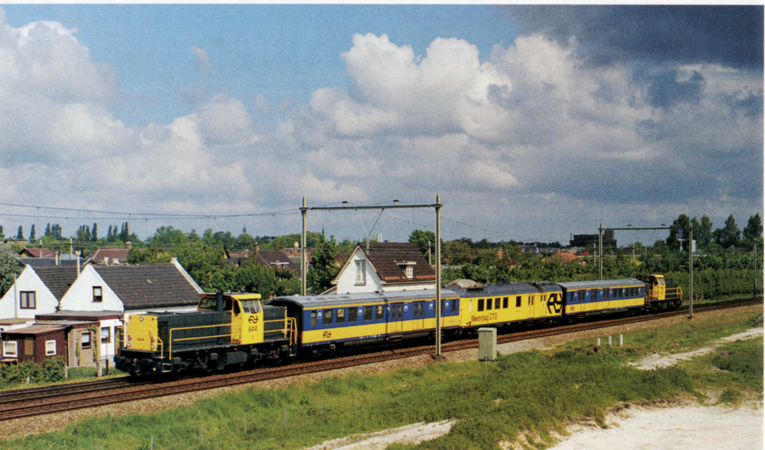
8. De NS meetrein (samengesteld uit het CTO meetrijtuig en de twee oude Plan E bagagewagens die werden omgebouwd tot fietstransportwagens) voor 't eerst getrokken door twee locs van de serie 6400. Voorheen werd deze taak verricht door de diesellocs reeks 2200. Foto: P. de Greeuw
