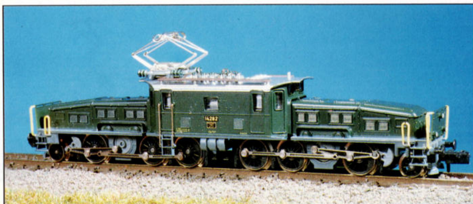
2. Zwitserse rangeer-krokodil met slechts één pantograaf. Een door Arnold te leveren variant.
