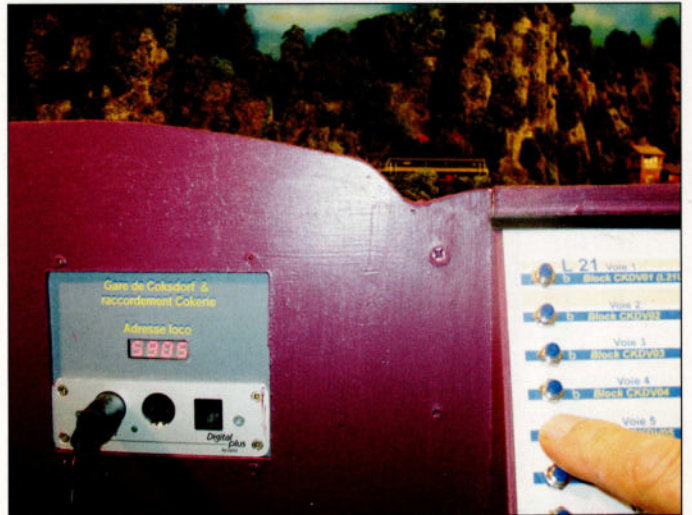
LRC120 de Lenz intégré dans un TCO. Ici, c'est une locomotive neuve ayant l'adresse 3 qui est détectée.
