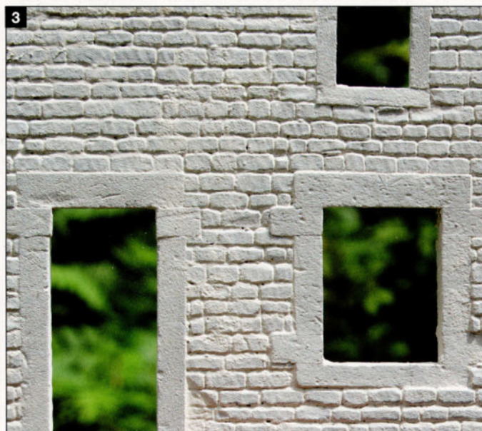
Photo 3: Après séchage, les joints présentent, du fait de leur retrait, des creux encore trop marqués, comme cette vue en lumière rasante met en évidence. Un décalage excessif apparaît aussi en l'encadrement et la fenêtre.
