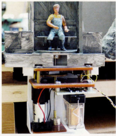
La mécanique de l'arrêt est de conception 'maison'. Un moteur entraîne une roue dentée et grâce aux contacts nécessaires, le relais est excité ou non.
