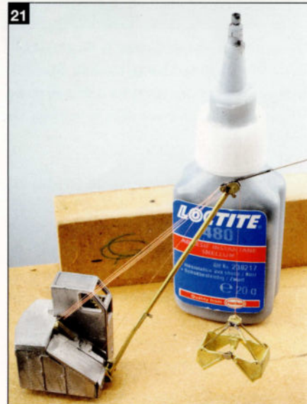
20. L'extrémité du câble de la pince est passée dans l'œillet de la poulie de la pince et torsadé autour du câble de la pince.
