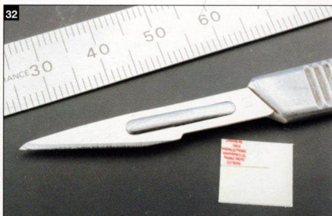
32. Le champ portant les inscriptions est coupé le plus près possible du texte. On utilise un scalpel très affûté, qui est tiré le long d'une règle en acier.
