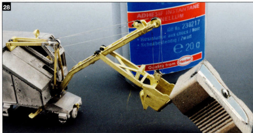
28. Pour que les câbles du godet soient également bien tendus, ce dernier est alourdi par un lest, lors du séchage.
