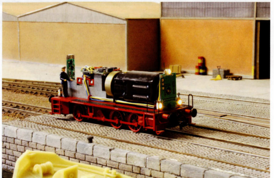
Les Leds blancs bleuâtres sont traitées au moyen d'une goutte de peinture jaune.
