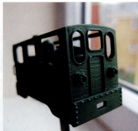
Le relief de l'impression reste visible, même après deux couches appliquées à l'aérographe. Plusieurs couches de primer donneront un meilleur résultat.
