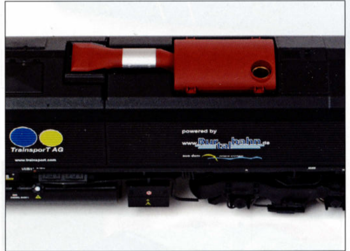
Vue de détail de l'échappement en toiture, avec l'orifice de remplissage du générateur de fumées.
