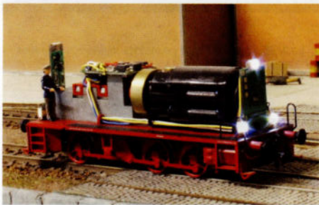
Les Leds blancs bleuâtres sont traitées au moyen d'une goutte de peinture jaune.
