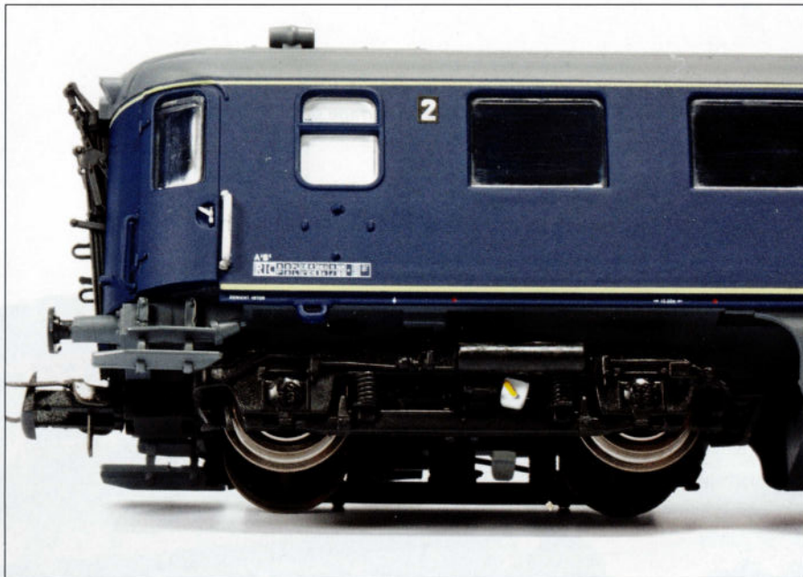
Les beaux bogies à claire-voie portent comme en réalité une dynamo de marque BBC. Sur les boîtes d'essieux, on peut lire le sigle NS.
