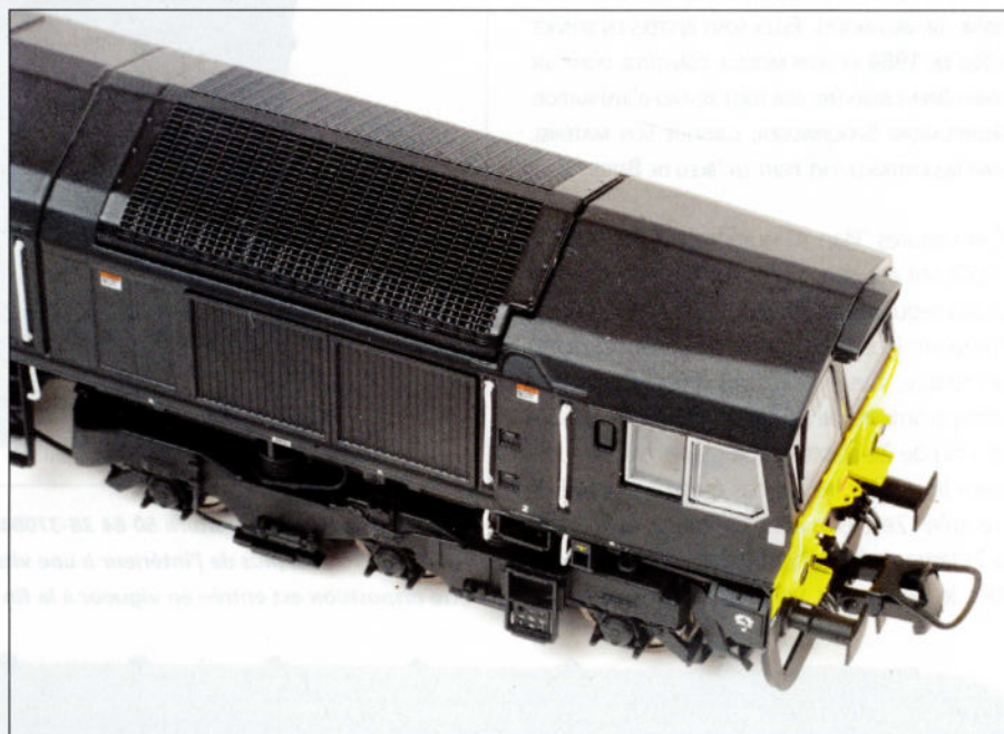
Les grilles de toiture sont remarquablement reproduites grâce à un tressage de fils très fins.
