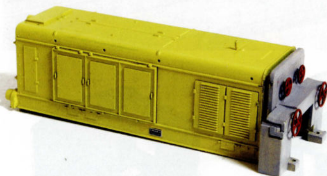
En masquant la plaque du constructeur avant la mise en peinture, vous obtenez un joli détail.
