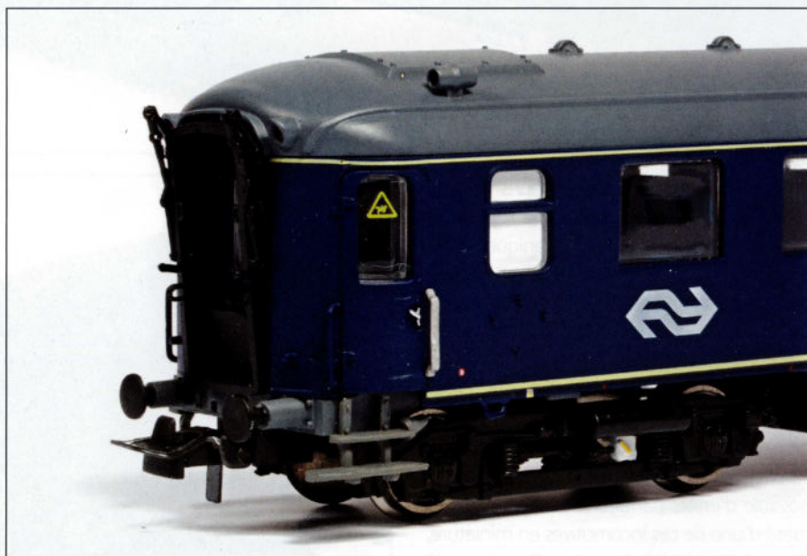
Une face d'about de la voiture 50 84 38-37084-5. L'autocollant jaune sur la fenêtre indique que la porte ne s'ouvre plus de l'intérieur à une vitesse supérieure à 5 km/h, mais bien de l'extérieur. Cette disposition est entrée en vigueur à la fin des années '70.
