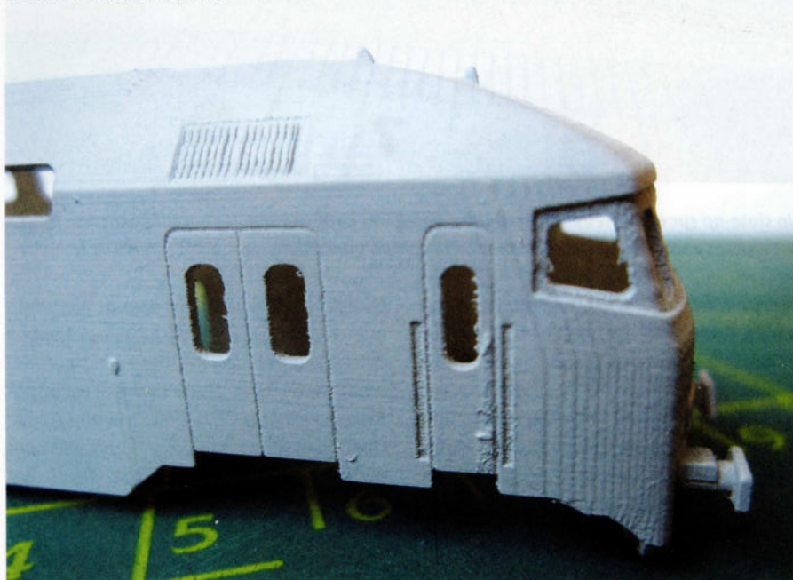
Là où la tête se termine de façon conique, les couches d'impression de 0,1 mm deviennent visibles. Bien qu'après mise en peinture, on n'en voit plus grand-chose, vous pouvez les éliminer au préalable au moyen d'un fin papier abrasif au grain fin.
