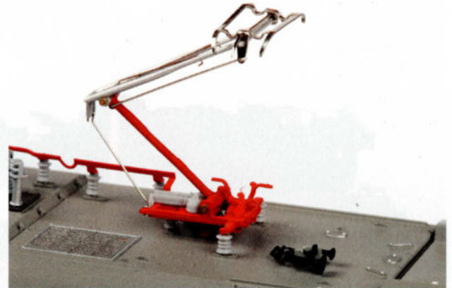
Les pantographes très fins sont en métal et pourvus soit de frotteurs larges (pour 3 kV), soit de frotteurs étroits (pour 25 kV).
