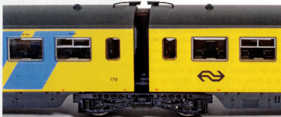
Sur les DE-2 reconstruits, les petites portes battantes ont fait place à des fenêtres. A côté de la fenêtre sur la caisse de droite, on peut voir des petites grilles.
