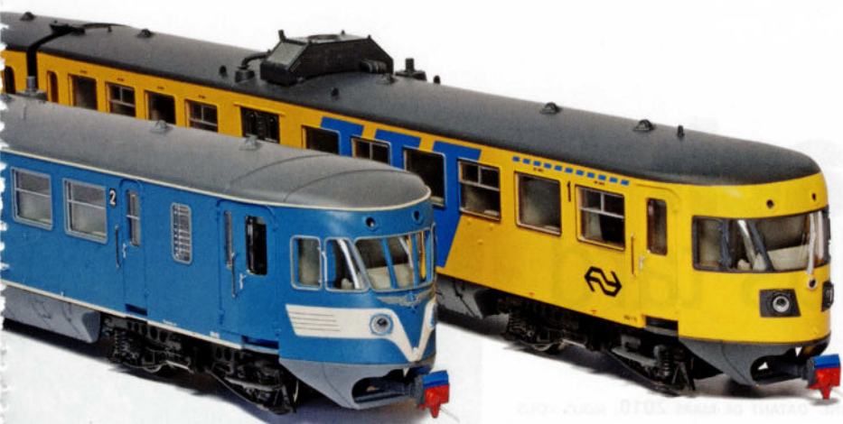
Les différences entre la version d'origine du DE-2 et la version transformée sont surtout visibles sur les nez. La cabine de la version jaune présente des plus grandes fenêtres, tandis que le compartiment de 1e classe a été aménagé à l'endroit du compartiment de service.
