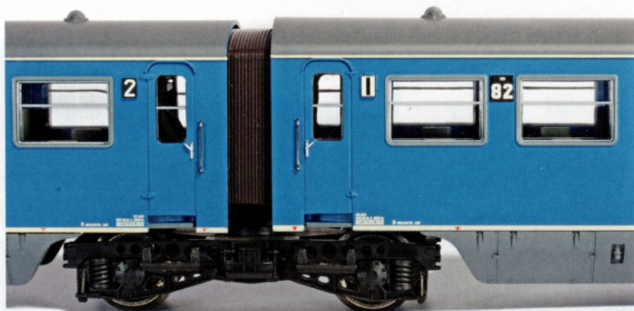
Le bogie Jacobs du DE-2 n° 82. Le raccord à tampons joints entre les deux caisses avec soufflet large ne s'ouvre pas, même pas sur des courbes serrées.
