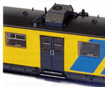
Le DE-2 n° 179 des NS. Les radiateurs et les silencieux disposés en toiture ont même été pourvus d'œillets de levage.
