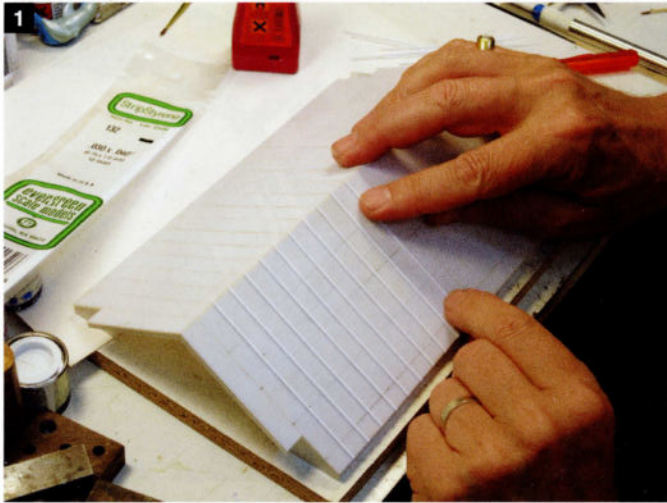
1 Des incisions sont d'abord pratiquées pour imiter les plaques de zinc.
