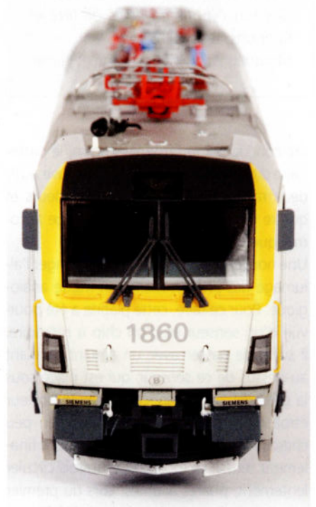
Les pare-brises affleurent parfaitement à l'encadrement noir. Le nom du constructeur (Siemens) apparaît au-dessus des tampons.
