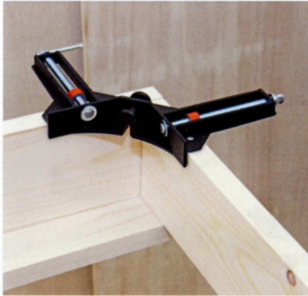
Un moyen d'aide pratique pour coller un coin droit est un serre-joints pour angle droit. Avec un tel serre-joint, des pièces d'épaisseurs diverses peuvent en outre être traitées.
