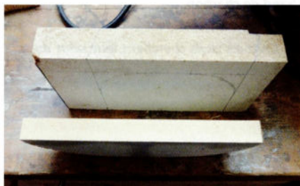
Du bois épais de 27 mm et fin de 18 mm.
