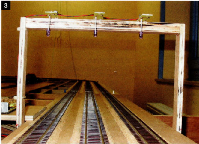
3. Les émetteurs sont placés à l'aplomb des récepteurs. Sur le circuit présenté ici, la distance maximum entre récepteur et émetteur est de +/- 30 cm. Si vous voulez augmenter cette distance, deux possibilités se présentent: - soit augmenter le courant dans la diode émettrice; - soit augmenter le nombre de diodes émettrices. Avec 4 diodes émettrices par exemple, il est possible de placer l'émetteur 150 cm plus haut !
