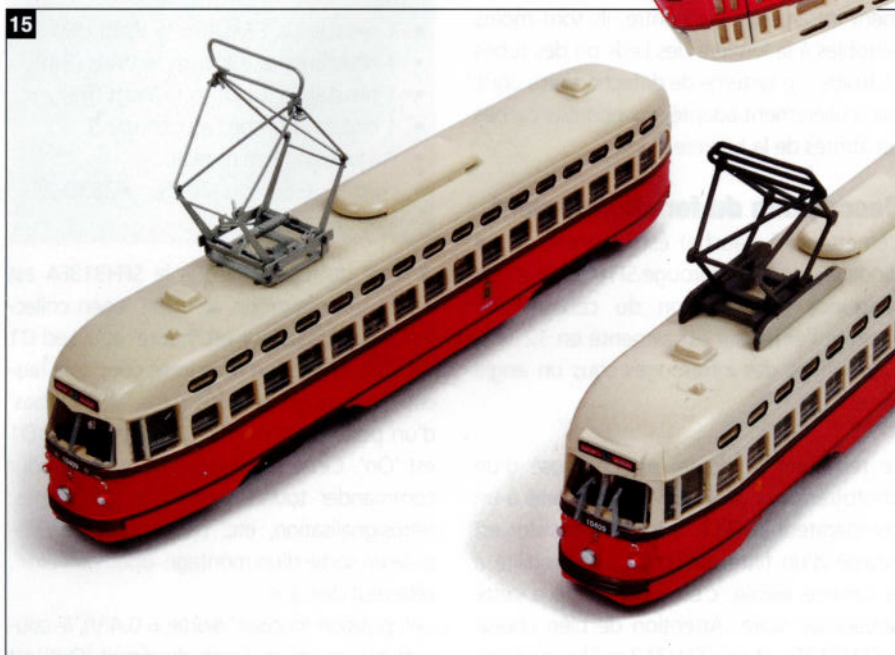
15. En comparaison avec le nouveau pantographe (à gauche), celui d'origine Atlas (à droite) ne ressemble vraiment à rien...
