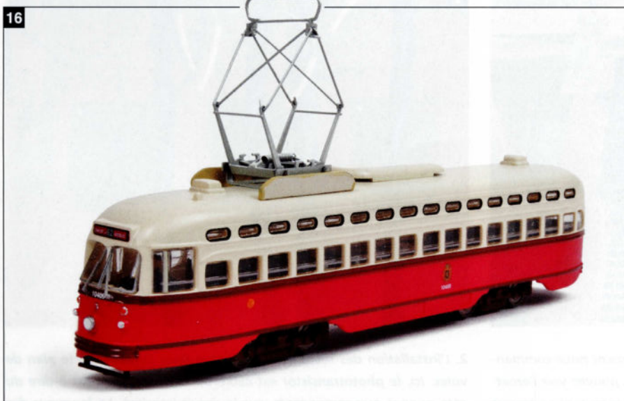
16. Nous avons récupéré les plaques latérales du panto sur le modèle Atlas et les avons collées sur le nouveau modèle Sommerfeldt. Des nouveaux essuie-glaces plus fins ont également été posés.
