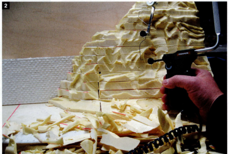
2. Les bandes de mousse dure sont collées les unes sur les autres jusqu'à obtenir un premier relief grossier. Les premiers contours sont alors découpés au moyen d'un cutter thermique Proxxon (modèle 12/E). Ceci donne une meilleure image des parois rocheuses à réaliser.
