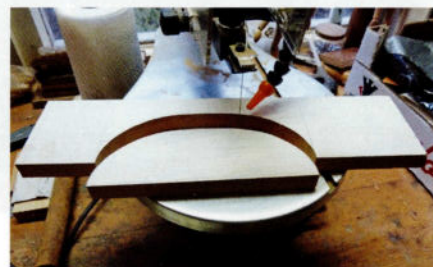
Un arrondi peut être fait à la scie pour découpe.
