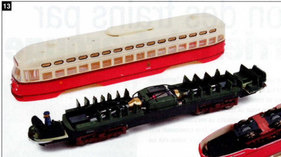
13. L'aménagement intérieur et la partie visible du châssis et de la suspension du moteur ont reçu une petite couche de peinture vert foncé.
