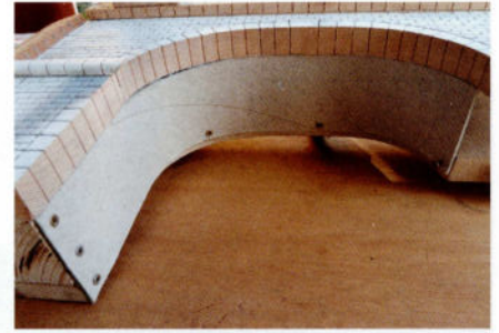
Le carton de l'arc intérieur est fixé à la colle pour bois. Vissez-le au préalable. Lorsque la colle sera sèche, les vis seront enlevées et les trous rebouchés.
