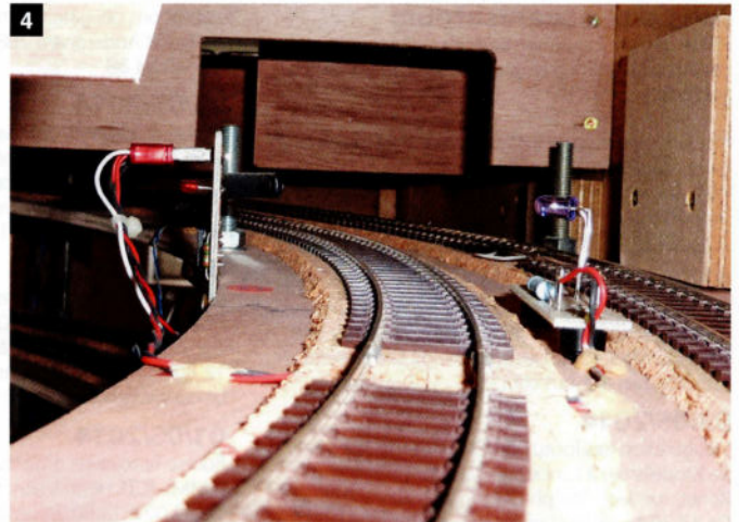
4. Il n'est pas toujours possible de disposer cette barrière verticalement (manque d'espace, etc.) Vous voyez ici une barrière infrarouge installée dans l'hélicioïde: il est impossible de placer les circuits au dessus ou en dessous des voies. Notez le petit tube noir sur le récepteur (à gauche): il sert à limiter l'angle de 'vue' du phototransistor et d'augmenter ainsi son immunité à la lumière ambiante.
