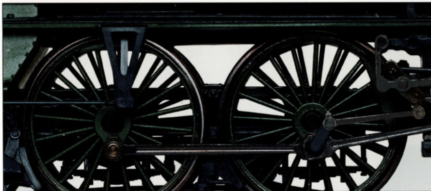
Châssis ajouré en barres finement détaillé, en métal coulé sous pression, vue dégagée.
