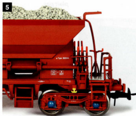
5. Au début, les crochets jaunes étaient disposés à chaque angle du wagon. Ils ont été déplacés et se trouvent désormais sur la traverse oblique sous laquelle les bogies sont montés.
