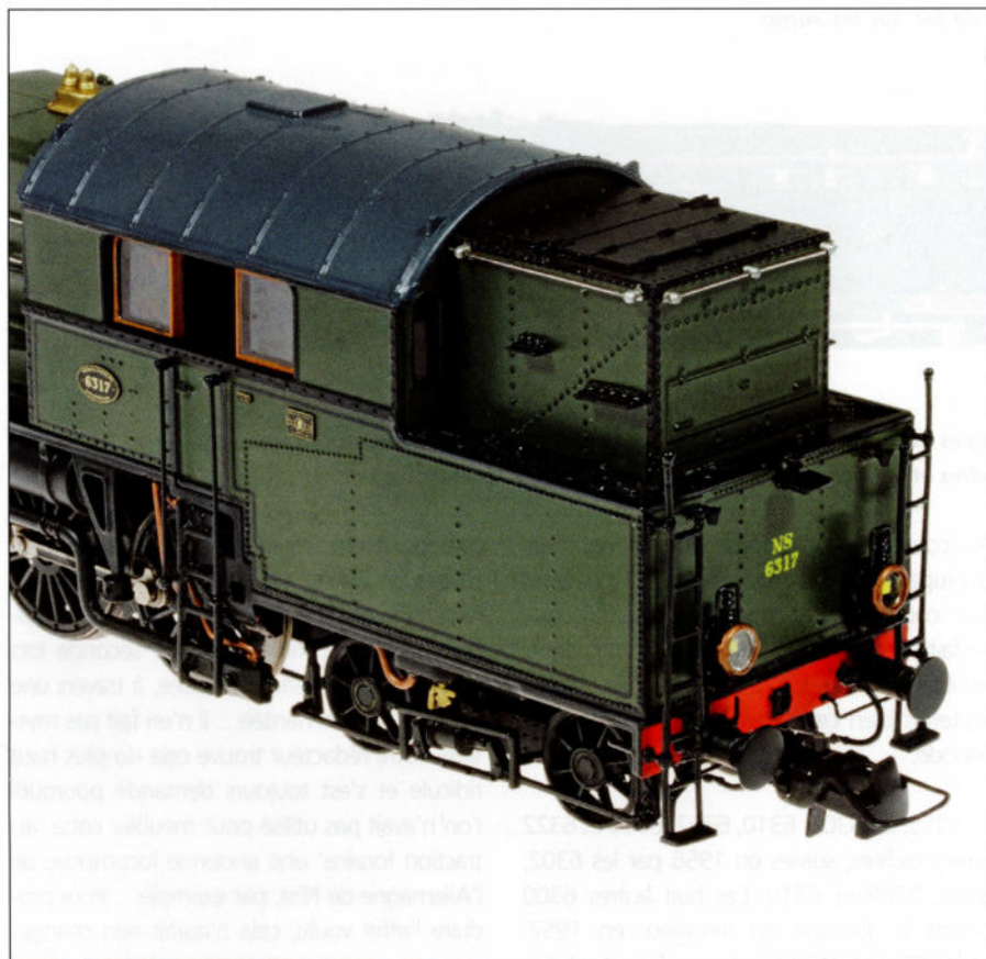
Les locos construites par Schwartzkopff avaient une soute à charbon surélevée, d'origine. Les marchepieds sur le flanc ont été installés en 1933.
