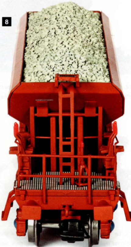
5. Au début, les crochets jaunes étaient disposés à chaque angle du wagon. Ils ont été déplacés et se trouvent désormais sur la traverse oblique sous laquelle les bogies sont montés.
