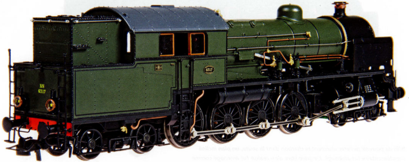
Ces locomotives étaient équipées de deux compresseurs, afin de produire suffisamment d'air comprimé pour les freins des longs trains de marchandises équipés du frein continu.
