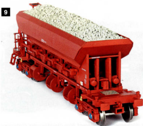
9. Van Biervliet sort le modèle qui présente deux cylindres de frein d'un seul côté entre les deux montants droits. La plupart des versions existantes en Belgique ne comptent qu'un seul cylindre: cette variante sera également reproduite plus tard.
