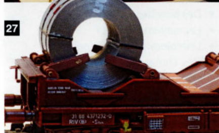
27. Détail d'un petit berceau et de ses petits bras de fixation associés.
