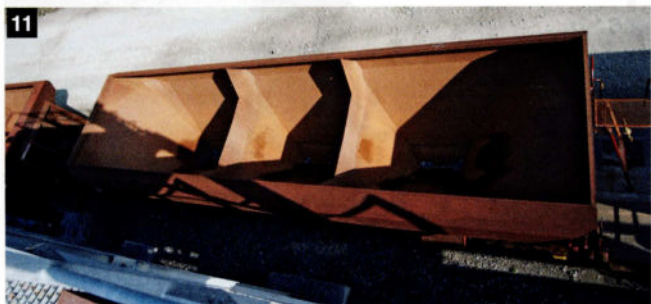
11. Sur cette photo, on voit bien les trois trémies qui débouchent sur six goulottes. Observez également le plancher en bois de la plateforme. Cette vue date de 2004 et a été réalisée depuis la tour de chargement du site CUP de Lessines.
