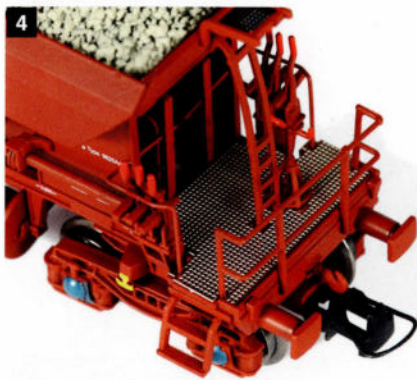
4. La plateforme présente de chaque côté trois leviers pour la commande des goulottes. Le frein à main est au milieu, au-dessus du bogie. Les leviers sont peints en rouge ou en jaune.
