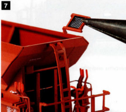
7. La coiffe au-dessus du marchepied et la plaque en laiton y associée sont livrées séparément: ces pièces s'ajustent parfaitement dans les trous prévus.
