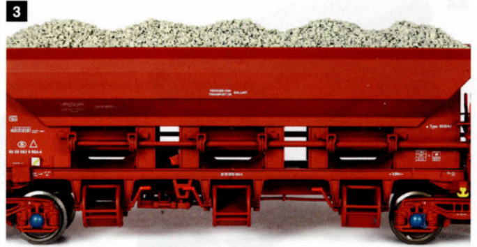
3. Les goulottes de déchargement peuvent être dirigées vers l'intérieur ou l'extérieur, avec le doigt. Les leviers qui servent à commander ces goulottes bougent de façon synchronisée.
