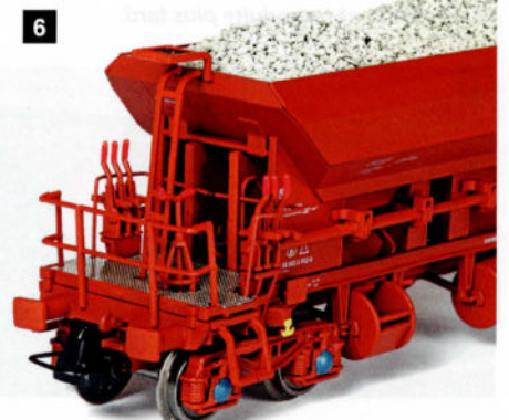
6. La plupart des wagons possède encore une plateforme en bois, mais on voit désormais également des plateformes métalliques en caillebotis. Van Biervliet a utilisé une plaque de laiton.
