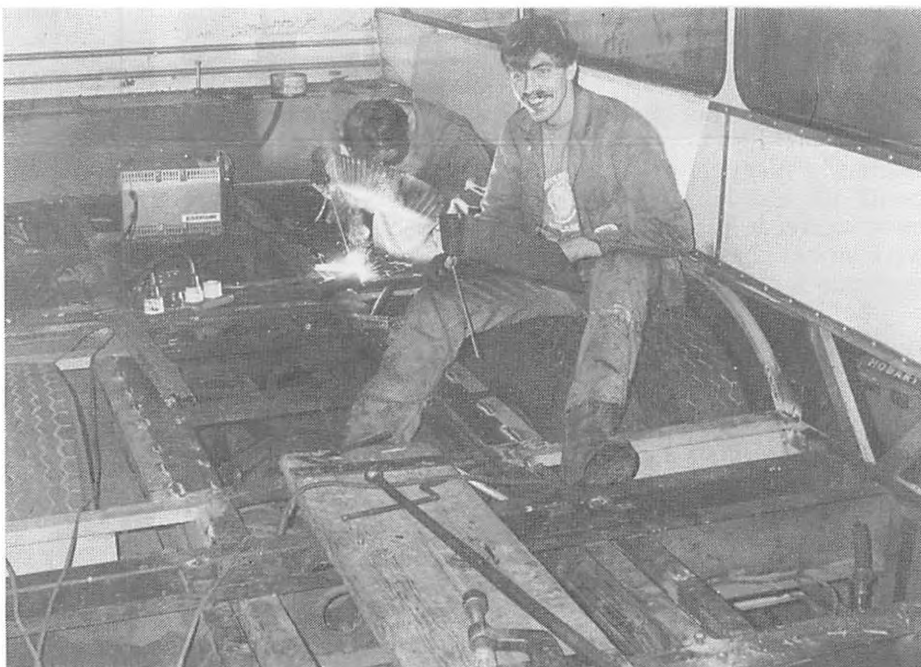
Jozef Van Giel en Frank Bassier tijdens het laswerk aan wat eens de vloer van de bus was.
