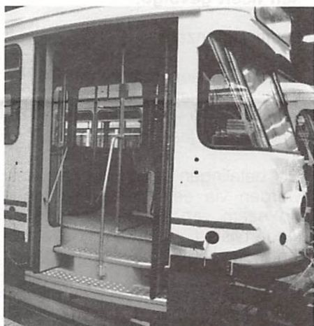
De verruimde deuropening met in het midden nog een steunstang. Reizigers met buggy of andere bagage krijgen nu meer op- en afstapruimte.
