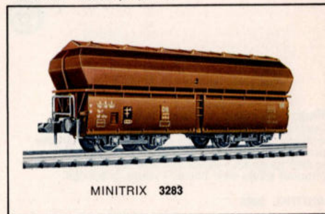
Wagon à grande capacité Uad-v-57 4 essieux, 2 bogies • wagon fermé • longueur totale env. 7,1 cm. • roues \phi 6,2 mm.
